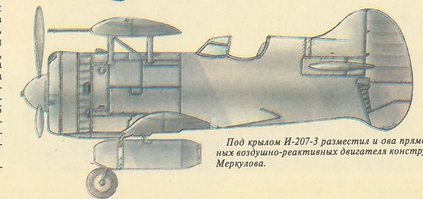
«Восьмерка» была оснащена убирающимся шасси, что дало заметный прирост скорости.
