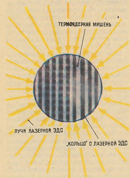
Рис. 5. Лазерная мишень с нанесенными кольцевыми проводящими дорожками для гибридного варианта термоядерного синтеза.
