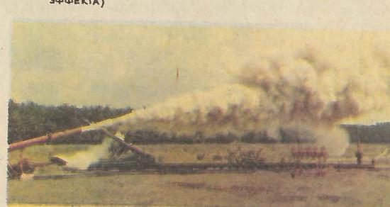
*Тушение пожаров воздушно-механической пеной. В пеногенератор под большим давлением подается вода из форсунок. За счет эжекторного эффекта в нее подается воздух. Воздушный поток с огромной скоростью попадает на систему мелкочешуйчатых металлических решеток, и поток тормозится на нем; вода, насыщаясь воздухом, взбухает, образуя пену. Затем она пневматически подается в ствол и выстреливается в цели.*
