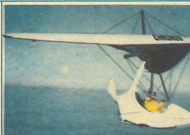
ни. Их оригинальный, до предела облегченный летательный аппарат ULM-C (несмотря на неразлучность братьев, все же одноместный) представляет собой нечто среднее между самолетом и моторным дельтапланом. Причем это не уникальное любительское изделие, а серийная машина с хорошо продуманной, простой технологией сборки. Всего лишь 14 стандартных элементов корпуса из пластика, упрочненного углеродными волокнами, быстро монтируются на клем и заклепках. Аппарат успешно прошел испытания во Франции и в США.
