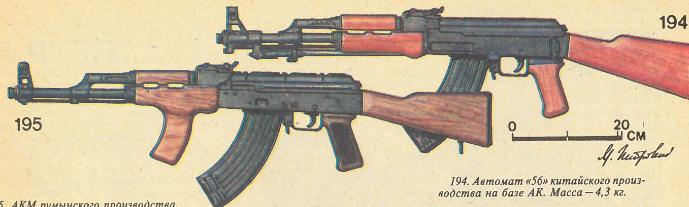
194. Автомат «56» китайского производства на базе АК. Масса — 4,3 кг.
