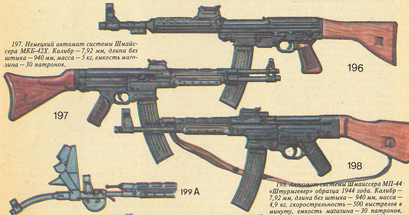
197. Немецкий автомат системы Шмайссера МКБ-42Х. Калибр — 7,92 мм, длина без штыка — 940 мм, масса — 5 кг, емкость магазина — 30 патронов.
