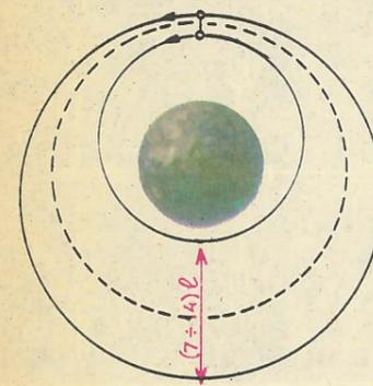
Рис. 3. Схема расстыковки при помощи троса (без затрат топлива) орбитального самолета и космической станции.  $l$  — длина троса. Пунктиром показана орбита в момент расстыковки, сплошными линиями — орбиты после расстыковки.
