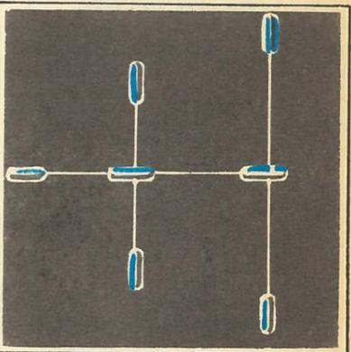
Из связанных спутников можно образовывать целые «созвездия». В них вертикальные тросы натягиваются за счет микрогравитации, а горизонтальные — за счет должным образом подобранной разности сил аэродинамического торможения спутников.
