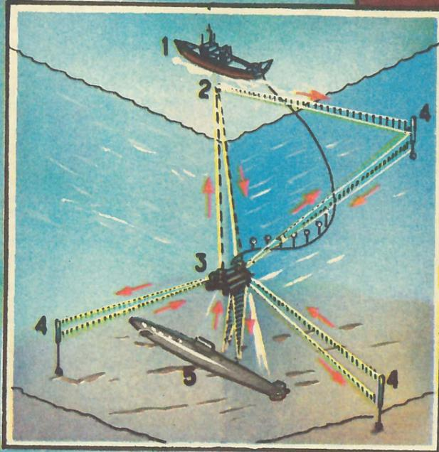
Один из вариантов подъема атомной субмарины предусматривает применение подводного «саркофага», в который будет помещен корпус с реакторным отсеком.
