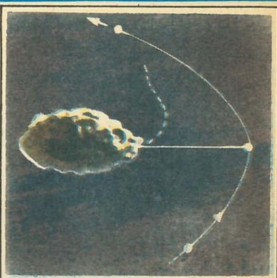
П. Пензо и Х. Майер предложили совершить облет вокруг астероида при помощи троса. По их идее с пролетающего космического аппарата выстреливается гарпун, который внедряется в поверхность астероида. Зажоренный таким образом спутник разворачивается, обрезает трос и уносится дальше, оставляя гарпун небесному телу на память о своем визите.
