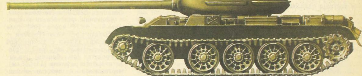
Бронирование, мм . . . . . лоб корпуса — 100, борт — 80, корма — 45, лоб башни — 200, крыша — 15, днище — 20
