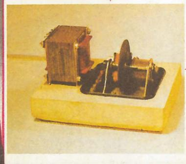
Еще одна интересная разработка «Таганки» — мотор на высокотемпературных сверхпроводниках для демонстрации эффекта Мейснера в школах, техникумах, вузах. В ванну заливается жидкий азот, благодаря чему возникает явление диамагнетизма и диск из иттриевой керамики начинает вращаться, отталкиваясь от индуцируемого катушками магнитного поля.
