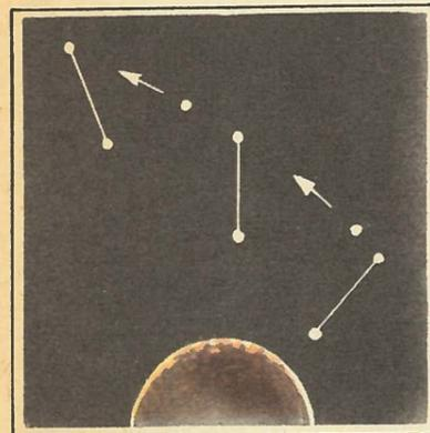
«Космический эскалатор» состоит из нескольких вертикальных связок. Груз сначала доставляется на нижнее тело первой, поднимается вдоль троса, затем в момент сближения перемещается на нижнее тело второй, поднимается вдоль ее троса и т. п.
