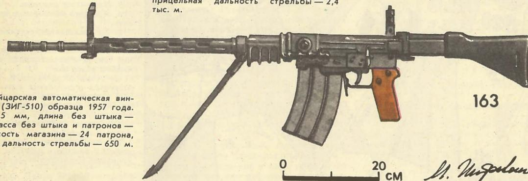
163. Швейцарская автоматическая винтовка М-57 (ЗИГ-510) образца 1937 года. Калибр — 7,5 мм, длина без штыка — 1100 мм, масса без штыка и патронов — 5,7 кг, емкость магазина — 24 патрона, прицельная дальность стрельбы — 650 м.
