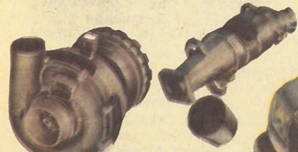
Механический центробежный нагнетатель с планетарным редуктором для системы наддува фирмы «ЦФ» (ФРГ).
