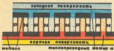
Схема полупроводникового термоэлемента.
