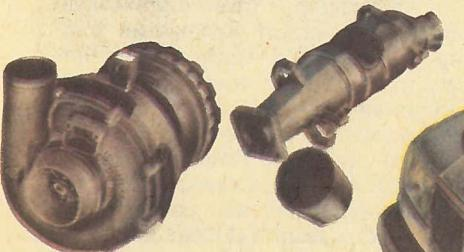
Механический центробежный нагнетатель с планетарным редуктором для системы наддува фирмы «ЦФ» (ФРГ).
