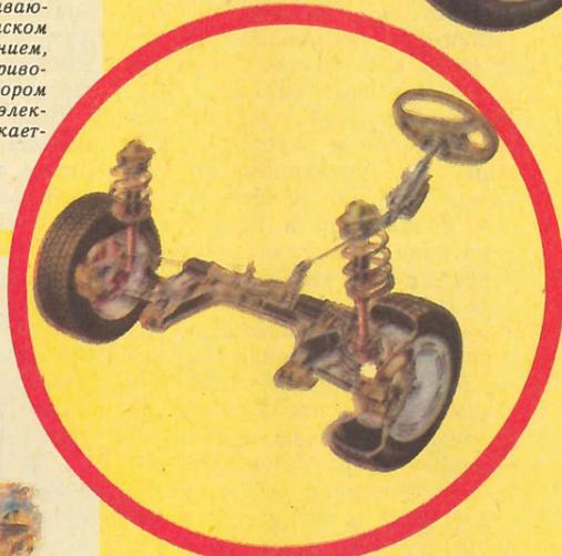
Передняя независимая подвеска типа «Мак-Ферсон» с электронной регулировкой жесткости амортизаторов. Ведущие колеса — с дисковыми тормозами и антиблокировочным устройством, рулевое управление — с сервоусилителем («Лянча-Дедра»).
