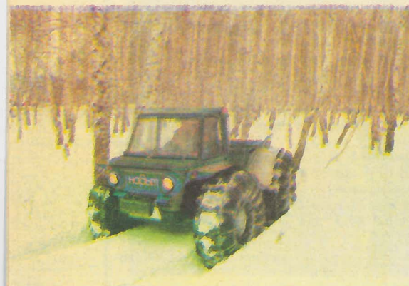
Надымский клуб «Вездеход» представил на конкурс 5 новых разработок. Две из них — на снимках: молодежный пневмокарт весом 250 кг и двигателем объемом 125 куб. см и грузовой вездеход В. Нелоева. Масса — 540 кг, дорожный просвет 43 см, кабина — цельнометаллическая, кузов — фанерный, двигатель — от мотоколяски. Все четыре колеса — ведущие, рама — «ломающаяся».
