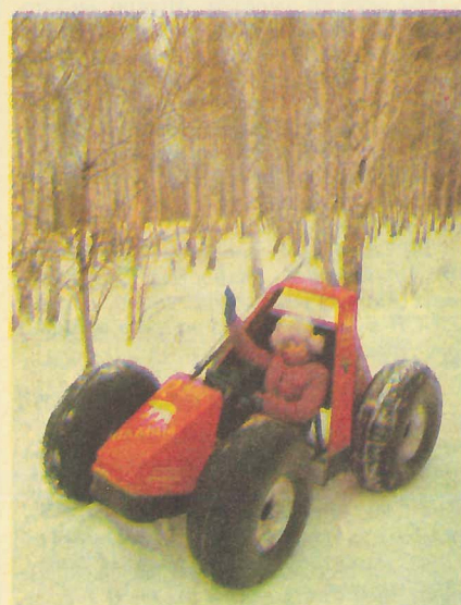
Надымский клуб «Вездеход» представил на конкурс 5 новых разработок. Две из них — на снимках: молодежный пневмокарт весом 250 кг и двигателем объемом 125 куб. см и грузовой вездеход В. Нелоева. Масса — 540 кг, дорожный просвет 43 см, кабина — цельнометаллическая, кузов — фанерный, двигатель — от мотоколяски. Все четыре колеса — ведущие, рама — «ломающаяся».
