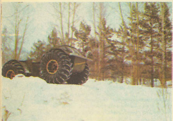
Возможности шины низкого давления демонстрирует В. Коновалов из Рыбинска на своей «Арктике-2». Давление колес очень мало, а это очень важно при движении по рыхлому снегу и легкоранимой растительной поверхности тундры. Кстати, в роли добровольца выступил корреспондент «ТМ».
