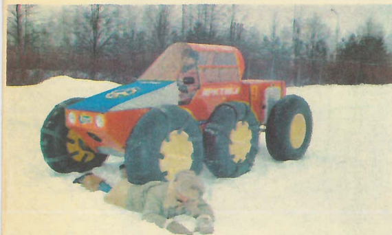
Пневмоход КСТТ Пермского объединения «Моторостроитель» выполнен по традиционной схеме на базе мотоцикла «Иж-Юпитер-5». Габариты — 1800×4000×2500 мм, снаряженная масса — 300 кг, дорожный просвет — 50 см, максимальная скорость — 80 км/ч. Авторы — Ю. Вагин, М. Зинатуллин и В. Тарасов. Это универсальное скоростное транспортное средство для любого времени года.
