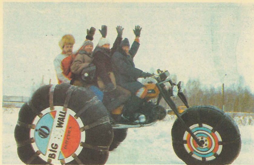
Пневмоход КСТТ Пермского объединения «Моторостроитель» выполнен по традиционной схеме на базе мотоцикла «Иж-Юпитер-5». Габариты — 1800×4000×2500 мм, снаряженная масса — 300 кг, дорожный просвет — 50 см, максимальная скорость — 80 км/ч. Авторы — Ю. Вагин, М. Зинатуллин и В. Тарасов. Это универсальное скоростное транспортное средство для любого времени года.
