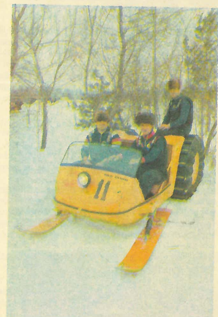
Всего 250 кг весит снегоход, разработанный в ОКБ Ступинского машиностроительного объединения. Полезная нагрузка — до 130 кг. Дорожный просвет — 21 см, но поскольку жесткость подвески регулируется — клиренс может меняться. Колеса снабжены мягкими грунтозацепами, что облегчает маневрирование. Двигатель — от мотоколяски. Авторы продолжают усовершенствовать свою конструкцию, надеясь довести ее до промышленного производства.
