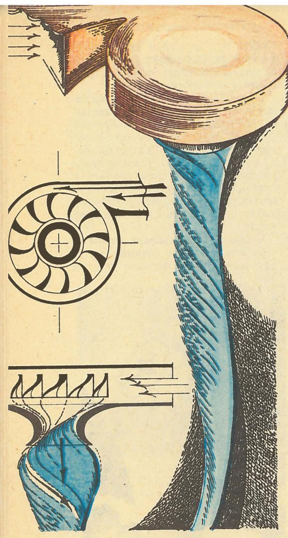
Воздушный поток, вырывающийся из вихревой камеры, состоит из дискретных вихрей.
