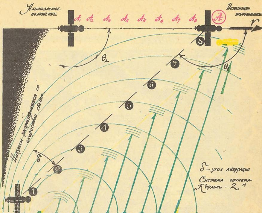
Рис. 2. Кажущееся и действительное положение объекта из-за искажения волнового фронта при движении.
