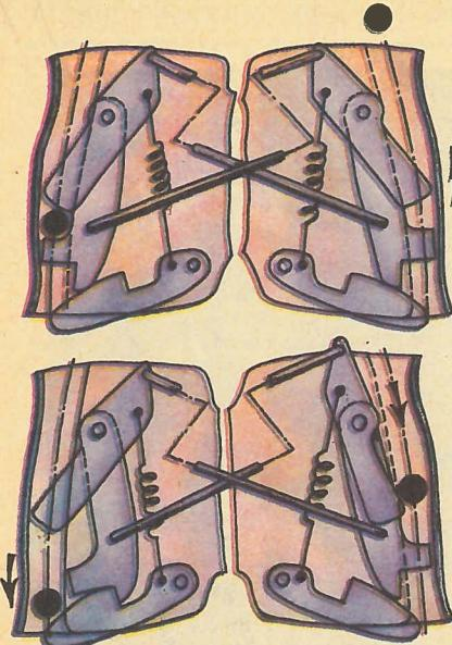
Захваты, при помощи которых ферма робота-мостовика склеивается и расцепляется с контактными столбиками (вид сверху).
