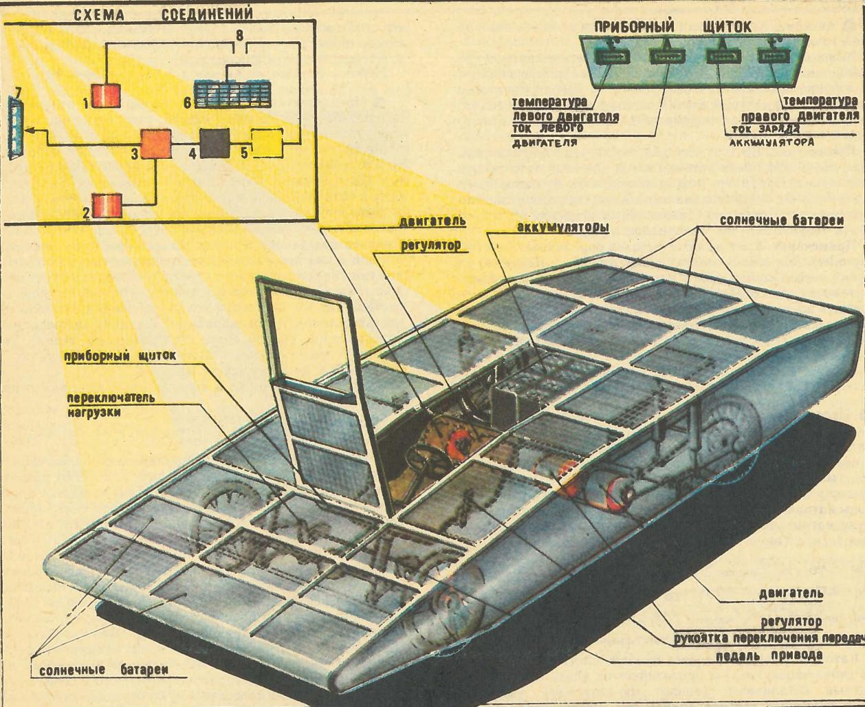
Первый отечественный солнцемобиль «Дока-гелио». Его размеры — 4500×800 мм, масса с аккумуляторами — 170 кг, суммарная мощность установленных электродвигателей — 1475 Вт.
