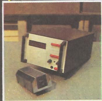
Непрерывный твердотельный лазер видимого диапазона ТЛН-Д-10. Одномодовое излучение, высокая амплитудная стабильность.
