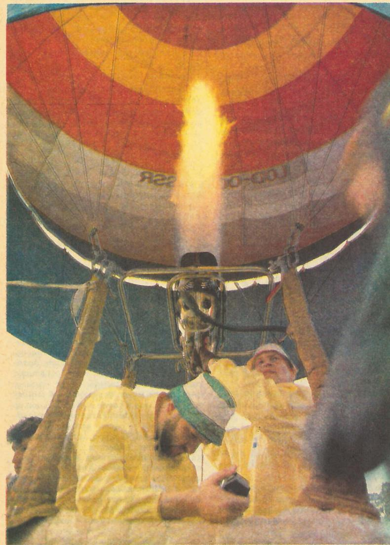
Аэростат на старте. Хорошо виден работающий теплогенератор.
