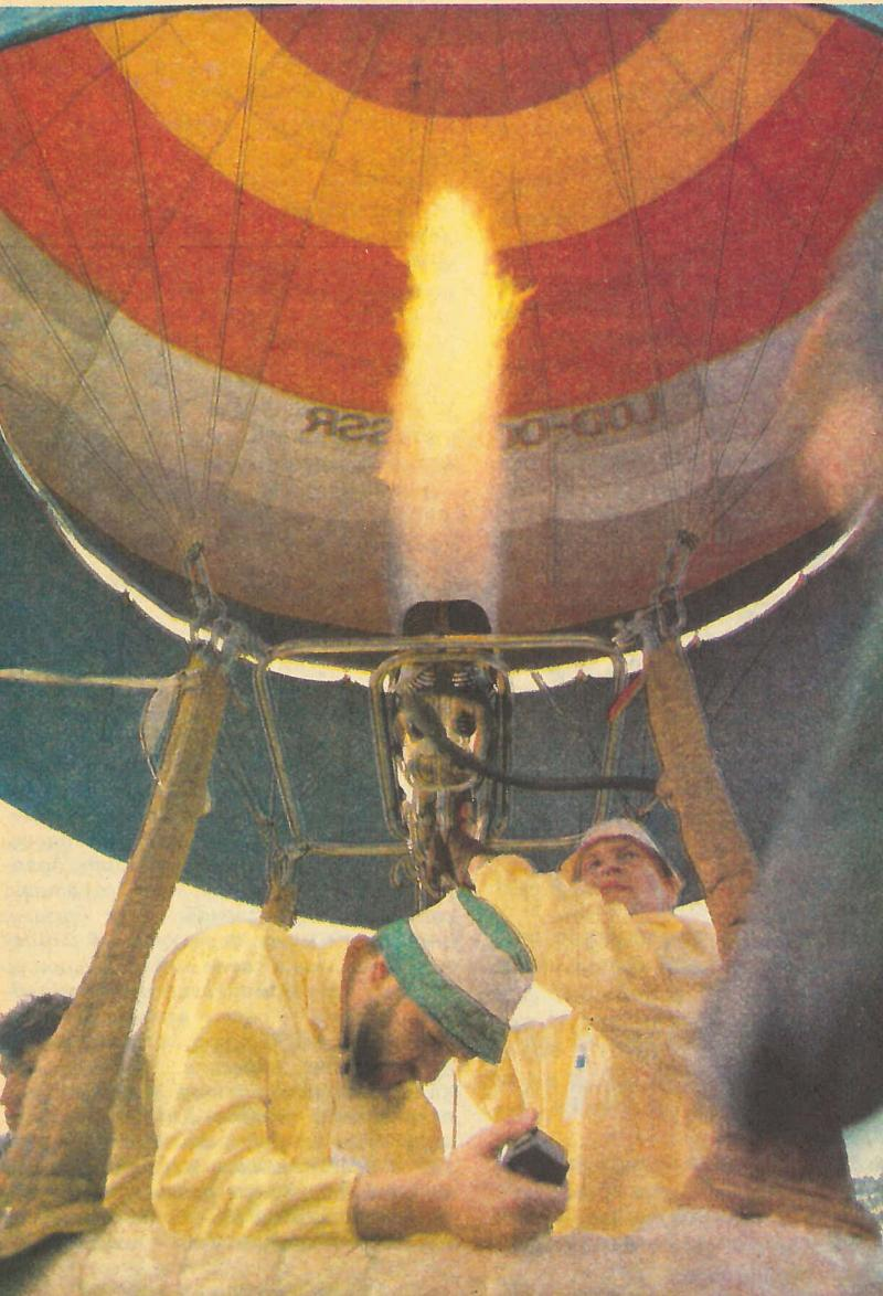
Аэростат на старте. Хорошо виден работающий теплогенератор.
