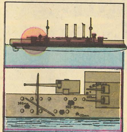
Попадания японских снарядов в броненосец «Орел» (вверху) и в японский броненосный крейсер «Ивате». Пробоины обозначены черным цветом.
