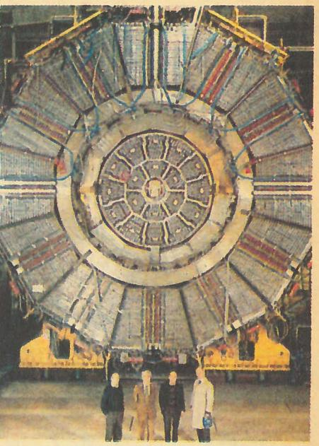
Пучки электронов и позитронов, бегущие навстречу друг другу по кольцу LEP, синхронизированы так, что сталкиваются в четырех точках тоннеля. Здесь вырублены подземные залы, где размещаются сложнейшие многотонные детекторы частиц.
