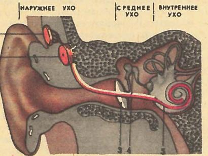
**«Искусственное ухо» группы специалистов из Дюренса (ФРГ).** Пучок электродов (1) разъединяется на контактной пластине (2) на 16 отдельных проводников, каждый из которых занимает предназначение для него гнездо. Пластина плотно прижимается к стенке улитки. Электрические импульсы раздражают рецепторы нервных волокон через стенку. Механические повреждения органа исключаются.
