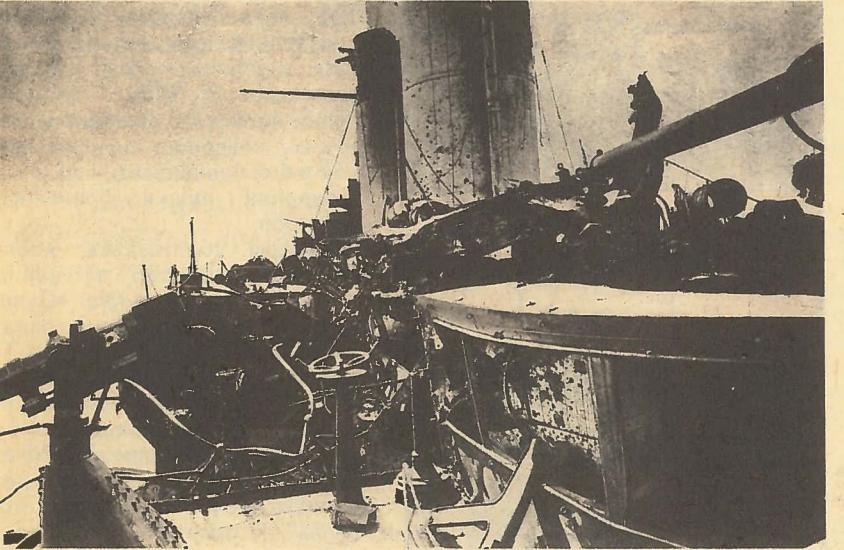
Защищенные броней борта башни и рубки «Орла» вынесли многочасовой артиллерийский огонь противника (слева), чего нельзя сказать о небронированных надстройках.
