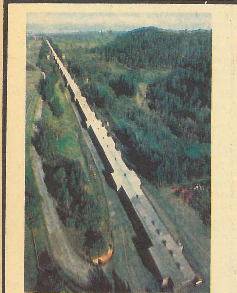
Станфордский линейный электрон-позитронный коллайдер SLC расположен частично на поверхности земли. Длина его линейной части — 3,2 км.
