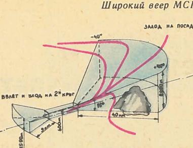
одновременно обслуживаемых системами): 2 и 200. Количество частотных радиоканалов: 40 и 200. Тип траектории посадки: ИЛС — прямолинейная; МСП — прямолинейные, сегментные, криволинейные. Влияние рельефа местности: ИЛС — сильное, МСП — незначительное. Обслуживаемые этапы: ИЛС — заход на посадку; МСП — заход на посадку, взлет, уход на 2-й круг.
