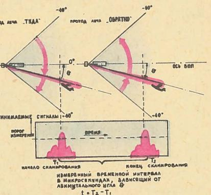
Принцип измерения азимута в МСП. Азимутальный угол в градусах равен простому математическому выражению  $V(T_2 - t)/2$ , где  $V$  — постоянная пересчета скорости сканирования в градусах на микросекунду.  $T_2$  — время прохода луча между крайними положениями.
