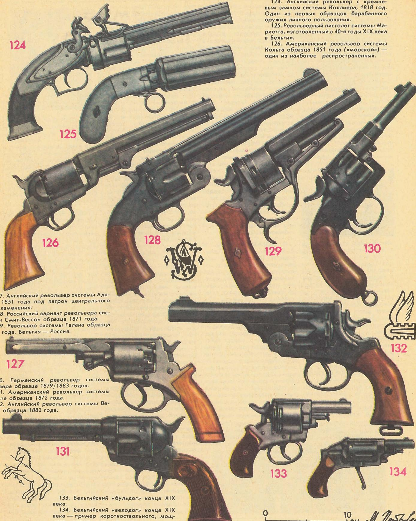
124. Английский револьвер с кремневым замком системы Коллиера, 1818 год. Один из первых образцов барабанного оружия личного пользования.
