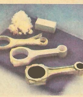
дикальное уменьшение веса машин. Армированные волокнами стеклопластики уже заменили значительную часть стальных листов в автомобильных корпусах. Однако для моторов они непригодны: нужна не только большая прочность, но и высокая термостойкость. И конструкторы начинают все сме-ле предлагать металлические композиционные материалы, на которые до недавнего времени претендовала только авиакосмическая про-мышленность. Их матрицы
