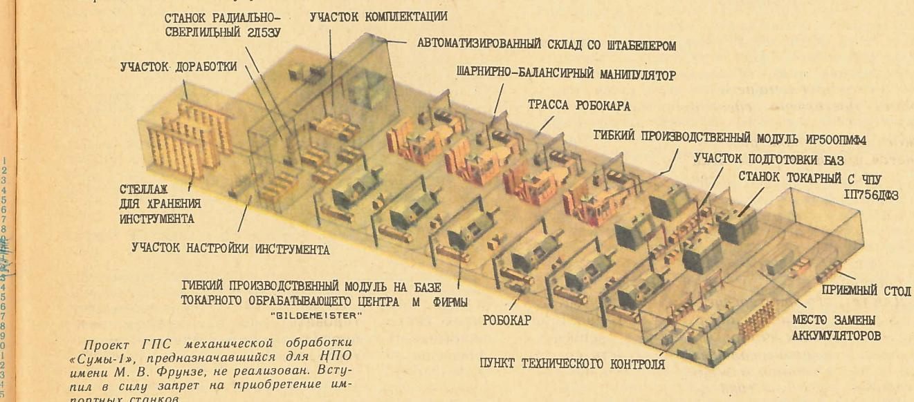
Проект ГПС механической обработки «Сумы-1», предназначавшийся для НПО имени М. В. Фрунзе, не реализован. Вступил в силу запрет на приобретение импортных станков.
