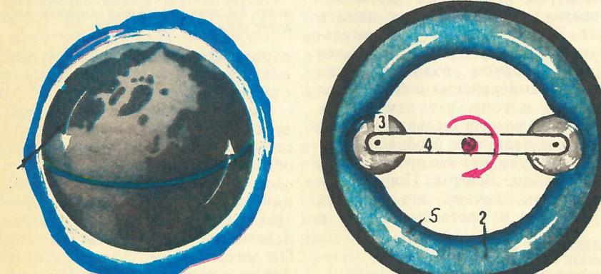
Рис. 2. Слева (а) показано, как «прокачивается» вода по оболочке планеты под действием приливных волн. Справа (б.) — сдавливающие кольцо, 4 — привод, вращающий ролики, 5 — направление движения жидкости.
