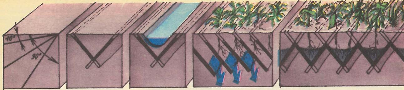
струями из глинистой супензии плотностью 1,05—1,1 г/см<sup>3</sup> даже без применения специальных гидроизолирующих компонентов образовывается слой водонепроницаемостью в 20—30 раз меньше окружения. А водоносные грунты и плывуны режутся обычной водой при одновременном заполнении щели густым тяжелым раствором глины с плотностью 1,2—1,3 г/см<sup>3</sup>. Он подается в рабочий орган из отдельной емкости и, пройдя в штанге по специальному каналу, истекает из ее нижней части в тыльную сторону.
