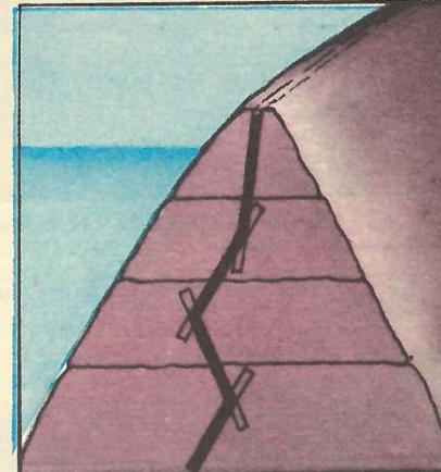
С помощью машин гидродинамического резания грунта можно создавать подземные водонепроницаемые экраны для русел каналов, для удержания влаги на сельскохозяйственных полях, для плотин.
