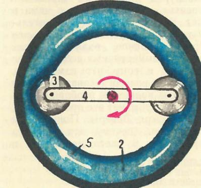
Условные обозначения: 1 — корпус насоса, 2 — эластичное кольцо, 3 — ролики, сдвигивающие кольцо, 4 — привод, вращающий ролики, 5 — направление движения жидкости.
