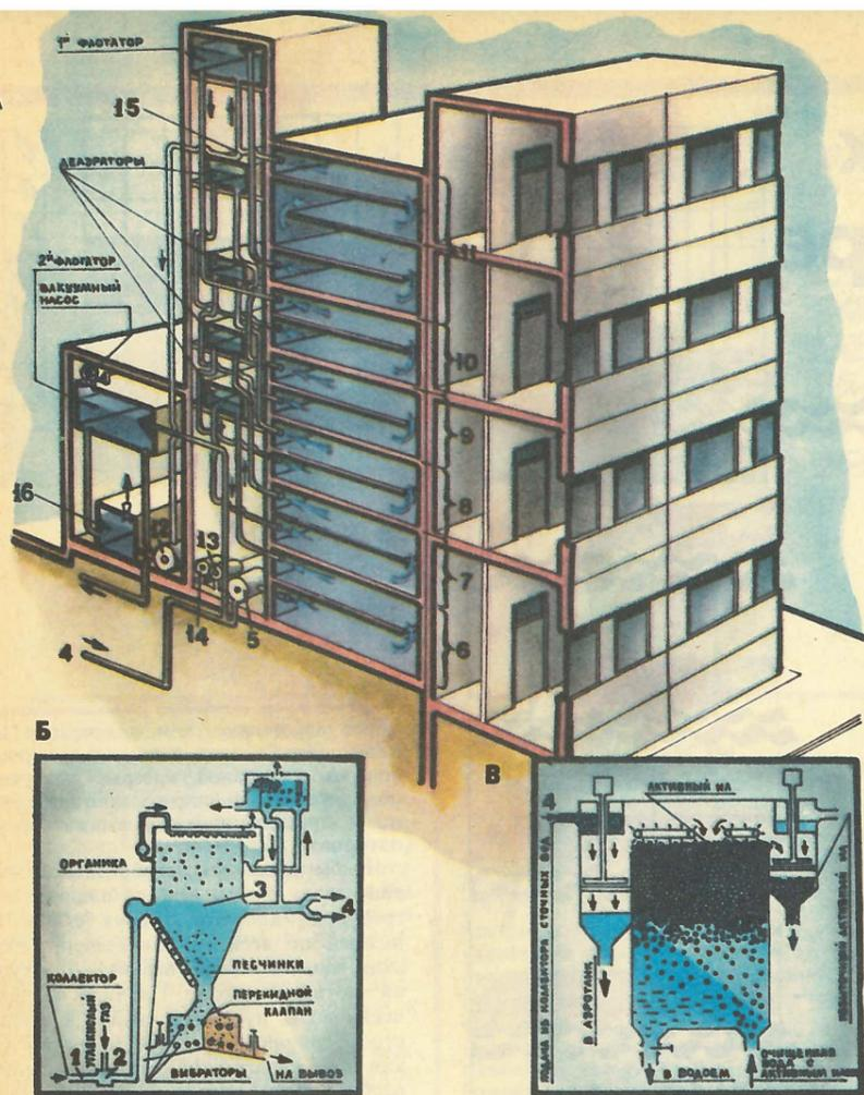
расстается с бактериями. Последние попадают в регенератор 11, там восстанавливаются их максимальная очищающая способность, и они в узле 15 вновь смешиваются с вытекающей из флотатора водой. Благодаря этому почти бесплатно можно достигнуть очистки на 99% — свежие бактерии добирают из воды остатки загрязнений!
