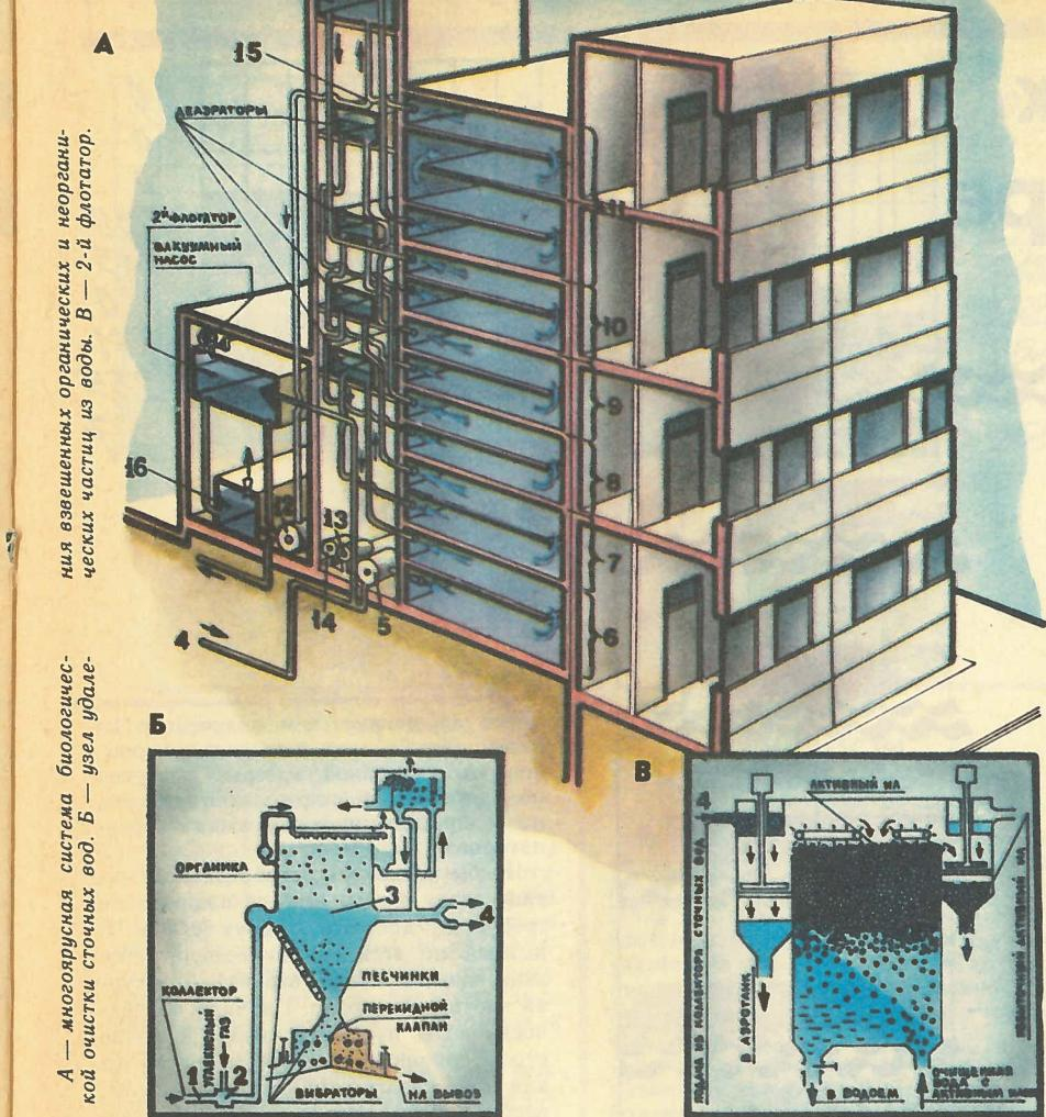
расстается с бактериями. Последние попадают в регенератор 11, там восстанавливаются их максимальная очищающая способность, и они в узле 15 вновь смешиваются с вытекающей из флотатора водой. Благодаря этому почти бесплатно можно достичнуть очистки на 99% — свежие бактерии добирают из воды остатки загрязнений!
