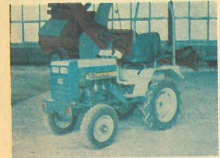
Малогабаритный трактор Харьковского завода Т-08: двигатель мощностью 5,9 кВт (6,7 л. с.); скорость — от 2,5 до 15 км/ч; длина — 1960 мм, ширина — 960 мм, высота — 1200 мм (с другой безопасностью); колея регулируется от 700 до 900 мм.
