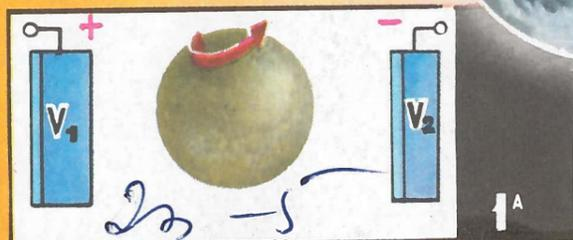
Если шар поместить между двумя электродами, с разными потенциалами,  $V_1$  и  $V_2$ , то он начнет вращаться.
