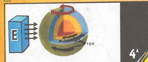
При вращении многослойного шара в неоднородном электрическом поле ток наводится во всех проводящих прослойках.
