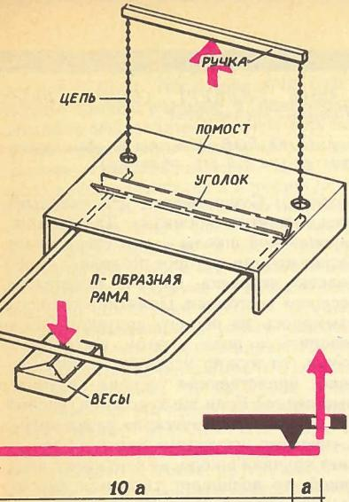
Тренажер Иванова. Тренирующийся с помощью «передаточной системы» — рамы и уголка оказывает давление на весы. Внizu — «схема передаточной системы», расположение сил.
