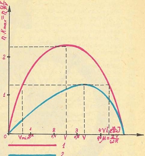
Рис. 5. Сравнение кривых эффективности ( $\eta_{K_{\max}}$ ) обычного винтового (2) самолета и машины Болдырева (1). Обозначения:  $M$  — отношение скорости потока от предкрылья или винта к скорости набегающего потока;  $\zeta$  — КПД силовой установки;  $G$  — полный вес аппарата или переносимой им полезной нагрузки;  $V$  — скорость перемещения груза;  $R$  — сила тяги, развиваемая силовой установкой;  $\omega$  — частота колебаний.
