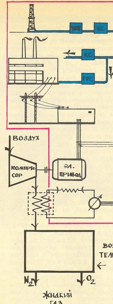
На схеме слева представлен традиционный способ получения жидкого хладагента с использованием электроэнергии. Справа: комплексный метод использования «попутного» холода для получения жидкого азота, органического топлива и очищенного природного газа.
