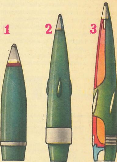
1 — современный снаряд традиционного типа, 2 и 3 — современные снаряды с готовыми выступами.
