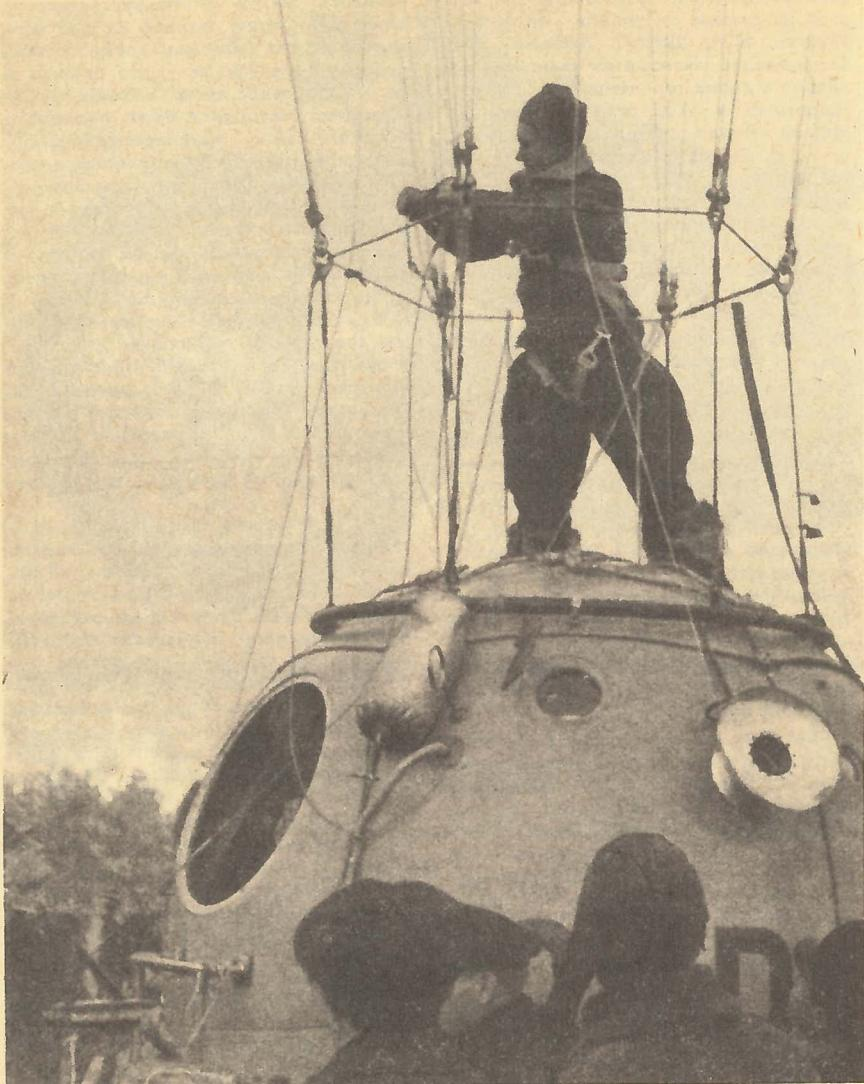
Аэронавты в последний раз проверяют крепление гондолы к оболочке.
