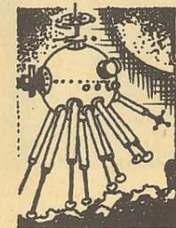
Сконструирован герметичный шар, снабженный направленными в сторону одного полушария элементами-опорами и благодаря вибратору перемещающийся прыжками с частотой, равной собственной частоте колебаний опор. Такой шар предлагается в качестве «венерохода» вместо неподвижных спускаемых аппаратов. На «марсоходе» же целесообразно использовать энергию дующих на «красной» планете сильных ветров.
