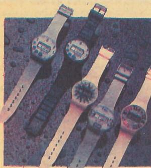
Электрохимический наливной элемент размером с монету, не требующий замены, вырабатывает ток в 10 микроампер. Вода проникает внутрь часов через отверстия по периметру. Остальное проделают цинковый катод и медный анод. Когда вода испарится, надо только бросить часы в стакан с водой, в бокал с шампанским или кружку с пивом, а если не
