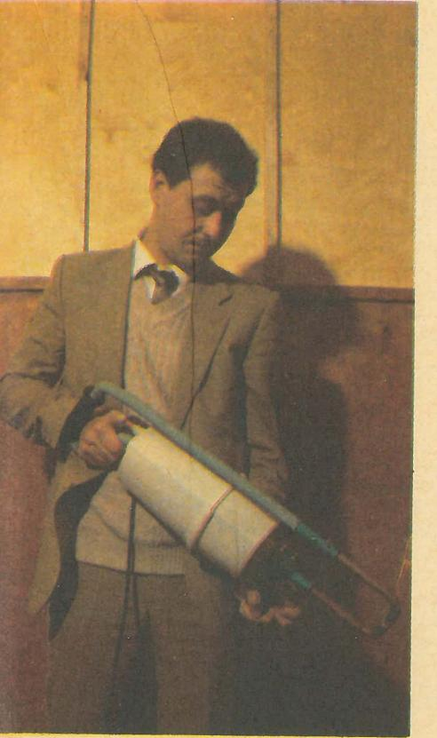
Аппарат точечной сварки бытовой, переносной.
