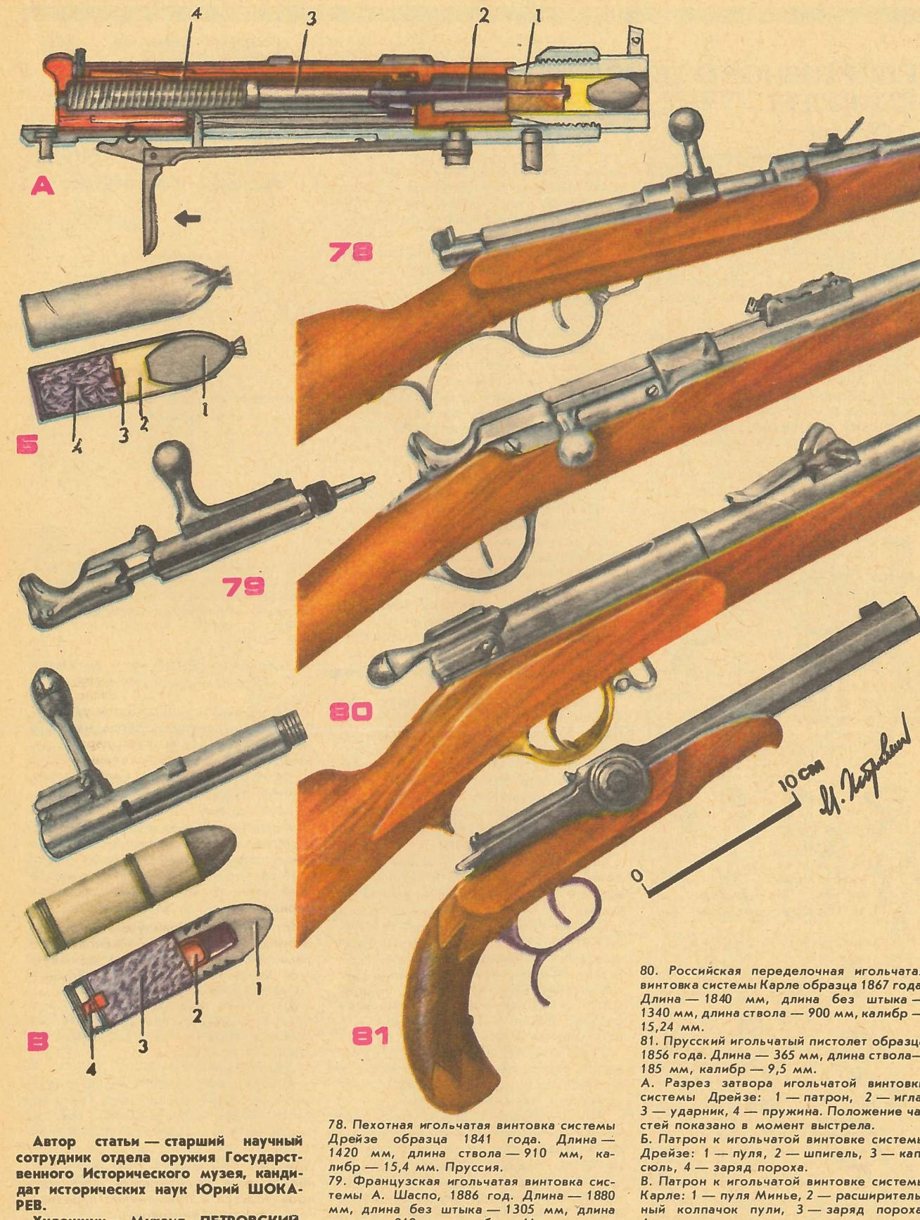
78. Пехотная игольчатая винтовка системы Дрейзе образца 1841 года. Длина — 1420 мм, длина ствола — 910 мм, калибр — 15,4 мм. Пруссия.
