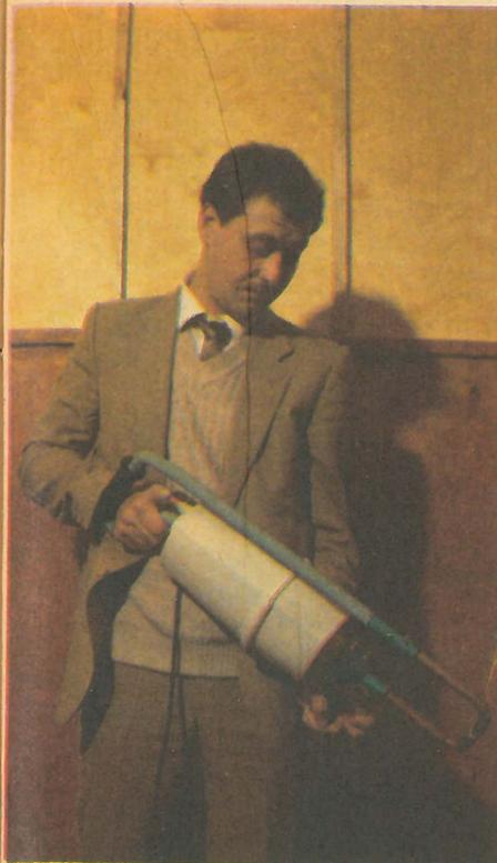
Аппарат точечной сварки бытовой, переносной.
