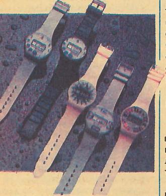
Электрохимический наливной элемент размером с монету, не требующий замены, вырабатывает ток в 10 микроампер. Вода проникает внутрь часов через отверстия по периметру. Остальное проделают цинковый катод и медный анод. Когда вода испарится, надо только бросить часы в стакан с водой, в бокал с шампанским или кружку с пивом, а если не
