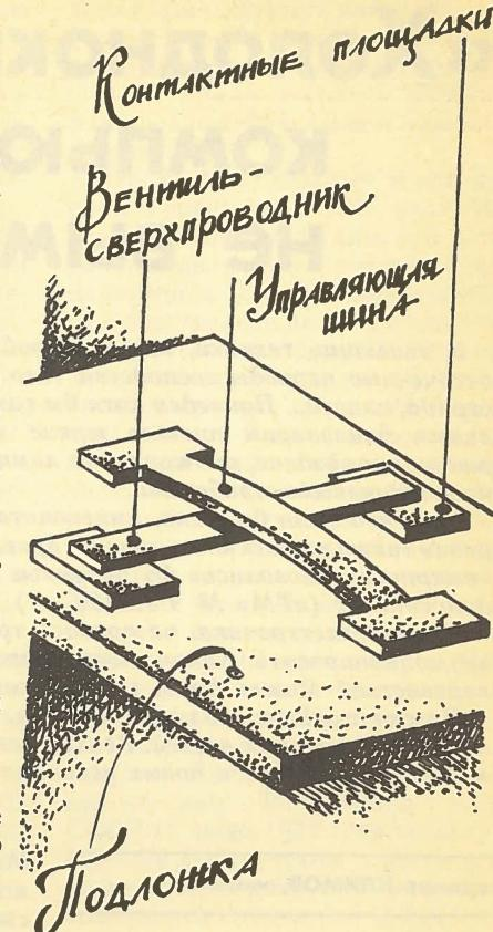
Рис. 5. Схема коммутации на криотронах.
