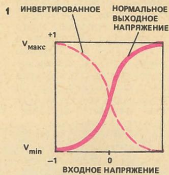
1 (см. график на рисунке 12) и подается на вход другого. Таким образом, усилители посылают друг другу «тормозящие» сигналы, поскольку высокое напряжение на выходе одного усилителя определяет низкое напряжение на выходе другого (см. схему б на рисунке). При этом быстро достигается одно из двух стабильных состояний: если усилитель А имеет выходное напряжение +1, то на выходе В будет -1 и наоборот.
