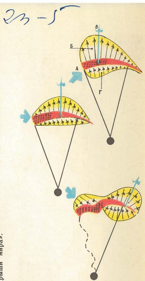
Профиль парашюта, ветер, силы. А — направление ветра; Б — эпюра сил, действующих на внешней части крыла; Г — на внутренней; В — подъемная сила.
