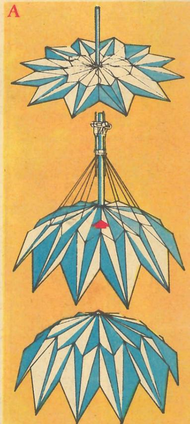
Метод подъема строители применяют нередко самым неожиданным образом. Вот несколько характерных примеров: А — возведение пространственной конструкции из плоских элементов, изготавливаемых на
