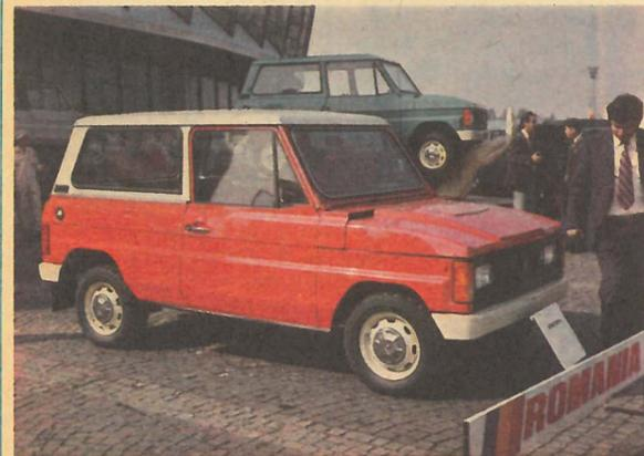
**«ДРО-24 ДИЗЕЛЬ»** — последняя модификация из семейства румынских вездеходов. По сравнению с предыдущими моделями, новый двигатель Л-27 имеет меньший вес при увеличении на 5 л. с. мощности, более легкий пуск, на 4 децибела снижена громкость выхлопа. Есть и другие преимущества: стал долговечнее передний мост, рулевой механизм, появился электронный счетчик оборотов, кондиционер, анатомические кресла. Новинку уже оценили те, кому часто приходится ездить по труднопроходимым дорогам.
