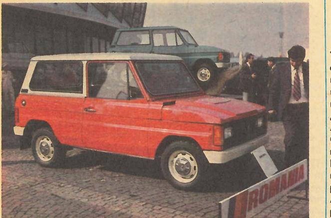
**«АРО-24 ДИЗЕЛЬ»** — последняя модификация из семейства румынских вездеходов. По сравнению с предыдущими моделями, новый двигатель Л-27 имеет меньший вес при увеличении на 5 л. с. мощности, более легкий пуск, на 4 децибела снижена громкость выхлопа. Есть и другие преимущества: стал долговечнее передний мост, рулевой механизм, появился электронный счетчик оборотов, кондиционер, автоматические кресла. Новинку уже оценили те, кому часто приходится ездить по труднопроходимым дорогам.
