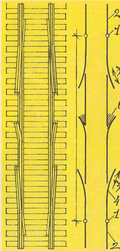
Стык «бархатного» пути: 1 — начало компенсирующей линейное расширение вставки, 2 — рельсовая плеть, 3 — направления перемещений вставки, 4 — перемещающиеся усовики рельсовых плетей, 5 — уравнивательная вставка, 6 — изолирующее соединение.
