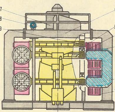
Новый роторный сепаратор. Цифрами обозначены: 1 — блок катушек, 2 — магнитопровод, 3 — электромагнитная система, 4 — блок роторов, 5 — дополнительный верхний полюс, 6 — рама, 7 — привод, 8 — питатели, 9 — ферромагнитные пластины.
