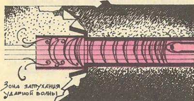
Портальная часть сглаживает резкий перепад давлений при выходе поезда из тоннеля.
