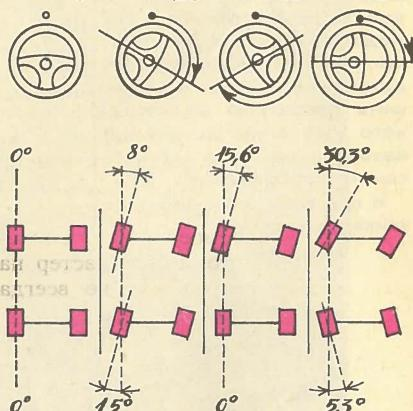
Задние колеса могут поворачиваться вслед за передней парой и в противоположную сторону. Первый вариант происходит при движении на высоких скоростях, второй — при медленных разворотах, например, при парковке на тесных улицах.
