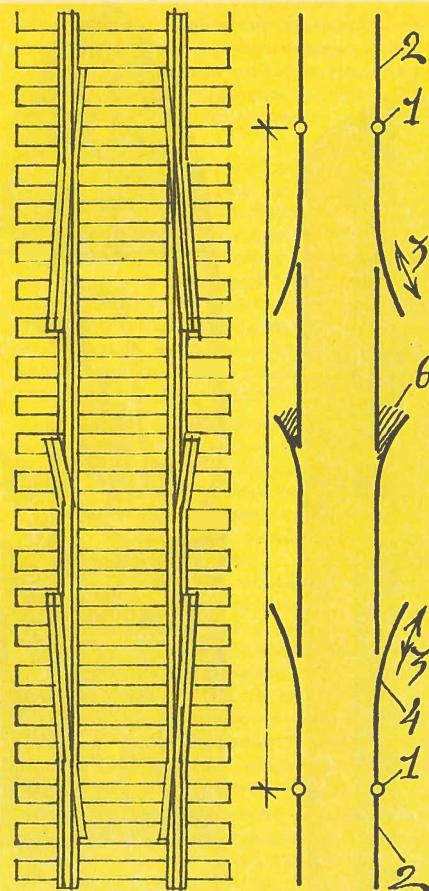
Стык «бархатного» пути: 1 — начально компенсирующей линейное расширение вставки, 2 — рельсовая пласть, 3 — направления перемещения вставки, 4 — перемещающиеся усовики рельсовых плеcей, 5 — уравнительная вставка, 6 — изолирующее соединение.
