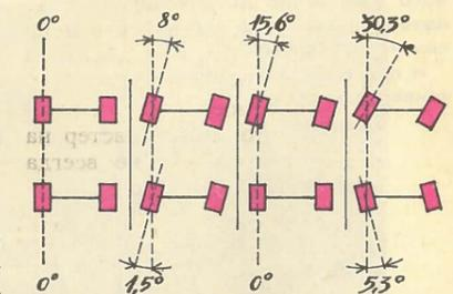
Задние колеса могут поворачиваться вслед за передней парой и в противоположную сторону. Первый вариант происходит при движении на высоких скоростях, второй — при медленных разворотах, например, при парковке на тесных улицах.
