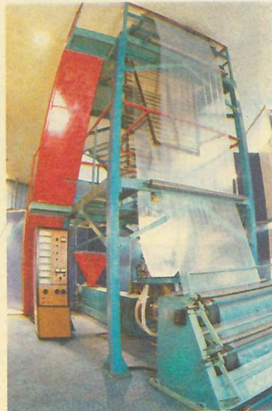
Линия для получения вторичного полиэтилена.
