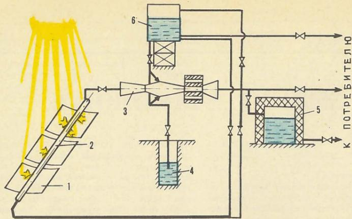
Гелионасос. Цифрами обозначены: 1 — солнечный коллектор, 2 — приемник, 3 — струйный насос, 4 — колодец, 5 — сборный бак, 6 — напорный бак.
