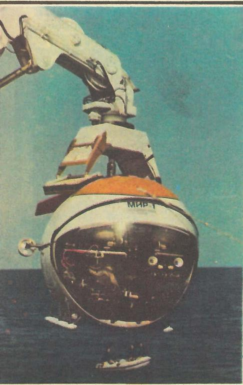
Мощный 22-тонный кран бережно опускает новый аппарат на воду.
