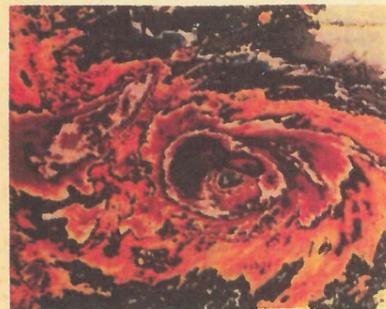
Вычислительная техника применяется теперь и для обработки фотографий из космоса. Снимок со спутника, запечатлел тайфун «Алиса» (сверху), закодирован в цвете. Это делает изображение более информативным, ведь окраска указывает на изменение физических параметров (например, температуры, влажности). Рядом — выполненный по такому методу снимок южных берегов США, Кубы и Мексиканского залива.
