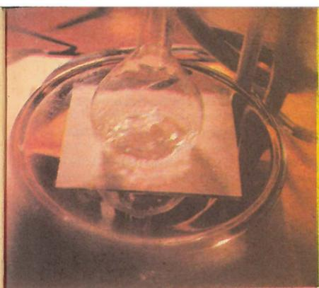
Это хитрое устройство называется магнитной мешалкой. В колбу с реактивами опускают металлический стержень, запаянный в стеклянную капсулу (для исключения коррозии), создают в нем переменное магнитное поле. Стержень начинает вращаться и быстро перемешивает смесь.
