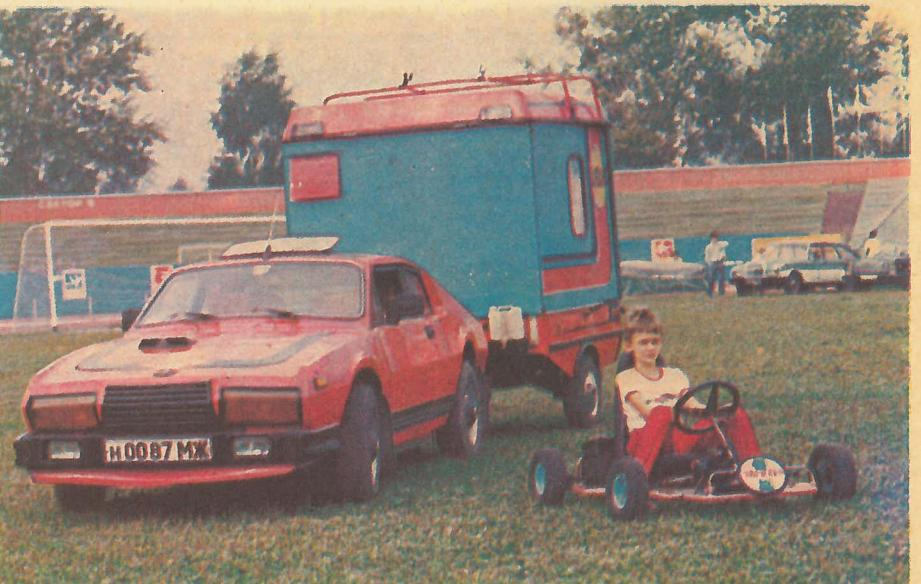
**ПРИЗ ТРЕТИЙ.** Автомобиль «Спорт-1200» Валерий Булычев из Подмосковья построил по рисунку дизайнера Э. Молчанова. Из стеклопластика по классической схеме размерами 4100×1600×1350. Четырехместная машина с агрегатами от «Жигулей» развивает скорость до 140 км/ч. При этом расходует 7 л топлива на 100 км.
