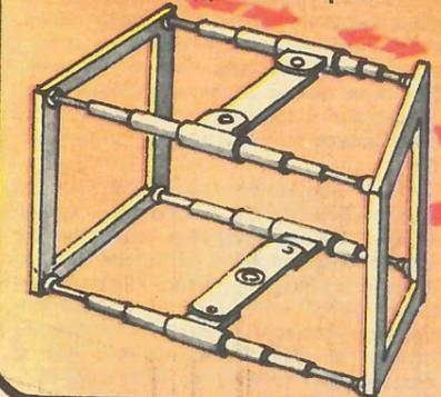
Соединительный блок между контейнерами: А — телескопически раздвигающиеся звенья контейнеров, Б — поперечное подвижное крепление, В — сворачивающийся напольный настил, Г — кожух-гармошка, Д — стыковочные рамы, Е — эластичная прокладка.
