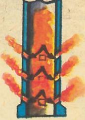
Д. Устройство дульного тормоза системы «Шнейдер».
