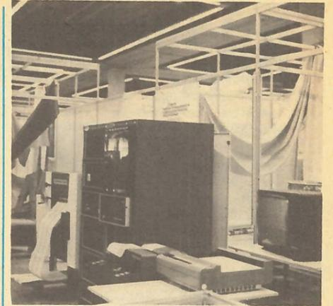
программу для жаккардового станка. Руководствуясь этой программой, станок начинает выработать полотно с новым узором. Вся переналадка занимает не более 4 дней.
