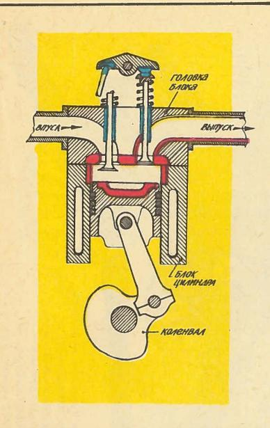
Пример использования керамических деталей в дизеле. Красным цветом обозначены теплоизоляционные элементы, синим — работающие на трение.
