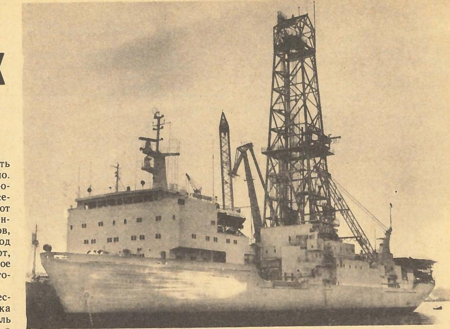
Буровое судно «Валентин Шашин» предназначено для бурения в дне моря разведочных скважин глубиной до 6500 м.
