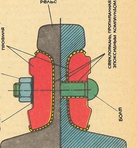
Клееболтовой изолирующий стык усиленной конструкции.
