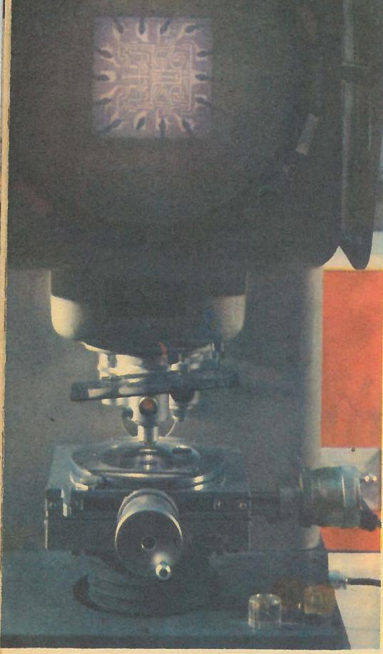
При проверке качества микросхем не обойтись без микроскопа.
