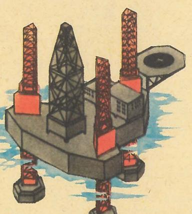
Самоподъемная буровая установка, построенная на Выборгском судостроительном заводе.
