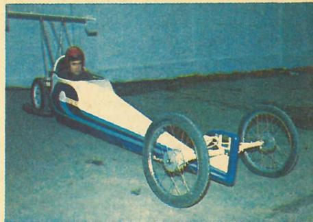
Дрегстер «ХАДИ-24». Двигатель одноцилиндровый, с рабочим объемом 500/750 см<sup>3</sup>, мощностью 75/80 л. с. Прочие характеристики: база — 3300 мм, передняя колея — 1000 мм, задняя колея — 375 мм, высота по кабине — 840 мм, клиренс — 23 мм, масса в снаряженном состоянии — 120 кг, скорость (расчетная) — 280 км/ч.
