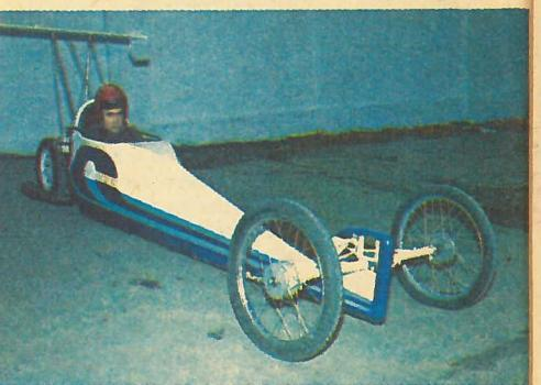
Драгстер «ХАДИ-24». Двигатель однцилиндровый, с рабочим объемом 500/750 см<sup>3</sup>, мощностью 75/80 л. с. Прочие характеристики: база — 3300 мм, передняя колея — 1000 мм, задняя колея — 375 мм, высота по кабине — 840 мм, клиренс — 23 мм, масса в снаряженном состоянии — 120 кг, скорость (расчетная) — 280 км/ч.
