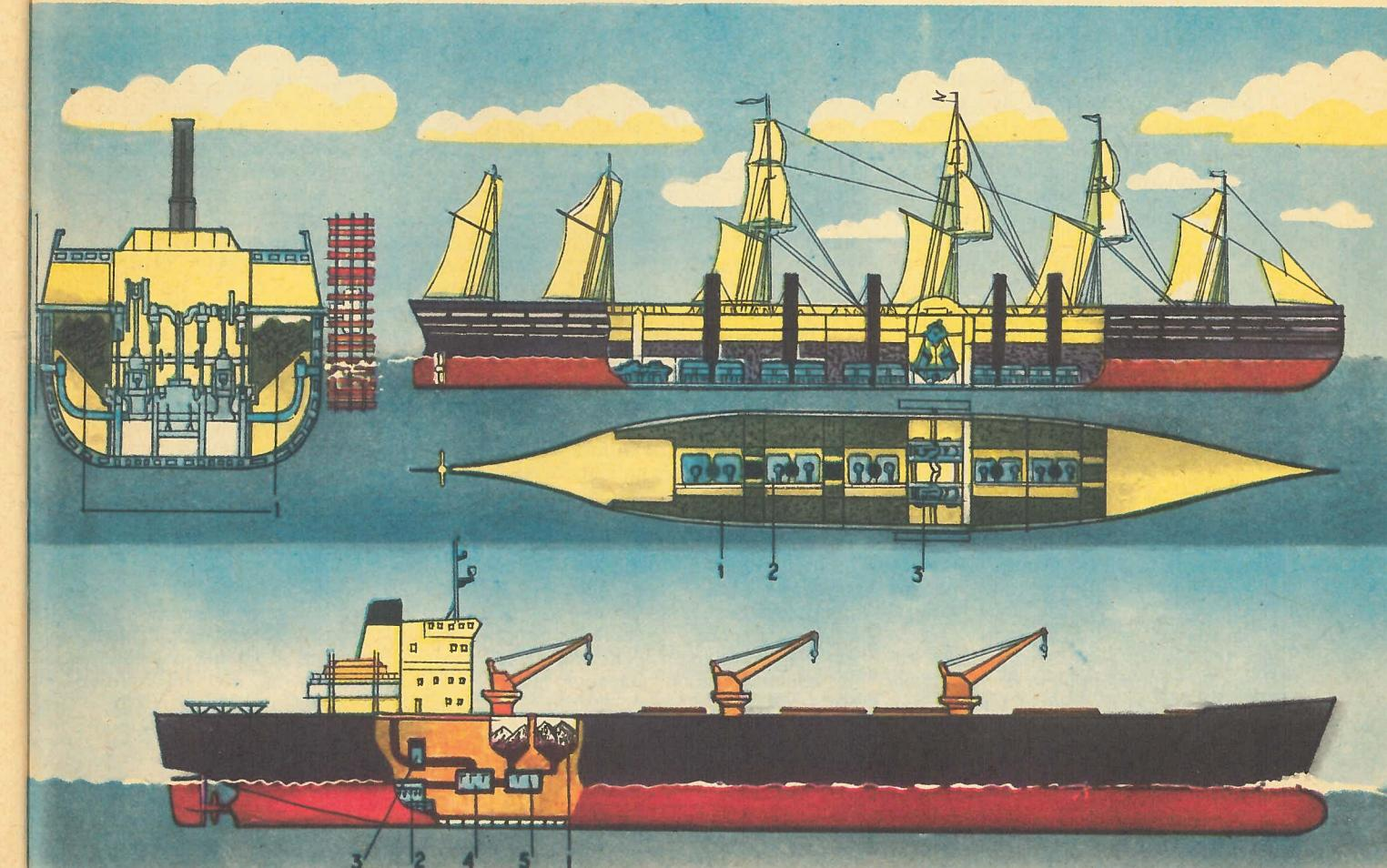
ра в них составляло 16 атм, температура — 300—325°C. Обычно машины Ленца давали от силы 70—90 об/мин. Напомним, что именно в этих условиях КПД гребного винта становится максимальным!
