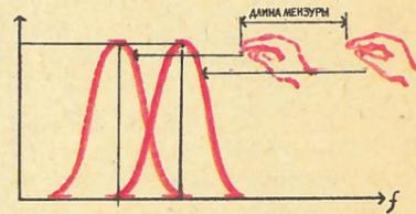
Схема изменения резонансной частоты при игре на «Тонике».
