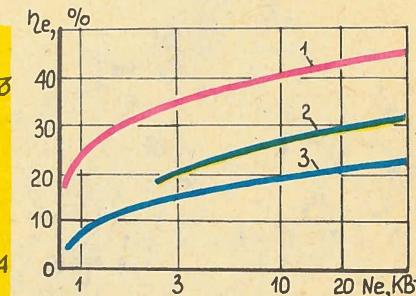
лопроводность и т. д. В результате уменьшается кпд и полезная работа цикла, которая определяется разностью между величинами работы сжатия и расширения тела. Тем не менее благодаря принципиальным термодинамическим преимуществам цикла в созданных ДС уже достигнуты большие значения эффективного кпд по сравнению с другими тепловыми двигателями одинаковой мощности (см. график).
