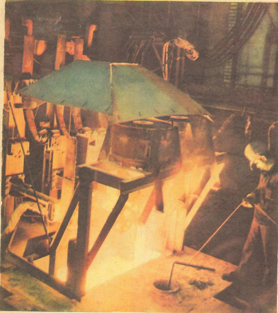
Идет процесс электрошлакового переплава.
