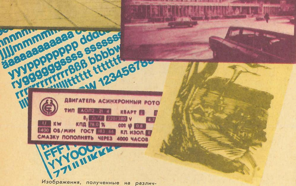
Изображения, полученные на различных материалах, покрытых светочувствительным слоем на основе ферроценовых соединений.
