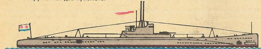
Подводная лодка Л-1 («Ленинец») Краснознаменного Балтийского флота. Водоизмещение надв.— 1025 т, подв.— 1321 т, скорость надв.— 14 узлов, подв.— 8,5 узла, мощность дизелей — 2400 л. с., мощность электромоторов — 1300 л. с., длина — 81 м. Вооружение: одна 100-мм пушка, один 45-мм полуавтомат, шесть торпедных труб, 20 мин.
