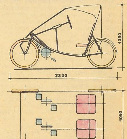
Москвичи отец и сын ПОПОЛОВЫ создали двухместный бытовой веломобиль «Божья коровка». В отличие от многих машин подобного назначения он выполнен четырехколесным.
