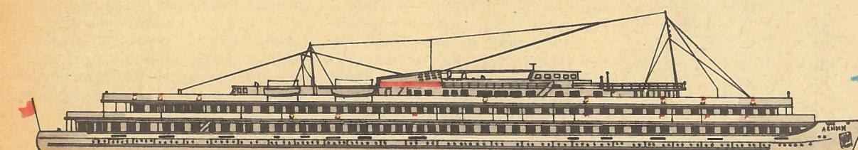
Пассажирский дизель-электроход «Ленин». Скорость — 27 км/ч, мощность силовой установки — 2700 л. с., длина — 116 м. Число пассажиров — 439, грузоподъемность — 80 т.
