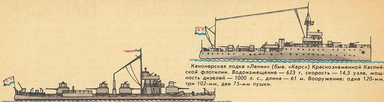
Канонерская лодка «Ленин» (быв. «Карс») Краснознаменной Каспийской флотилии. Водоизмещение — 623 т, скорость — 14,5 узла, мощность дизелей — 1000 л. с., длина — 61 м. Вооружение: одна 120-мм, три 102-мм, две 75-мм пушки.
