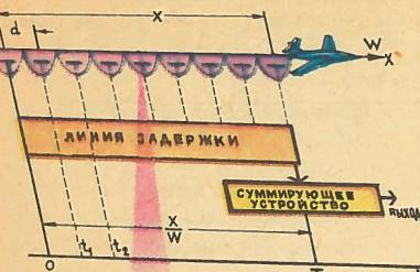
Схема обработки сигналов РЛС с синтезированной апертурой.
