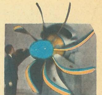
Макетный образец пропфэна с серповидными лопастями.
