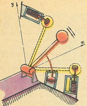
На рисунке изображена схема действия обычного робота. Двигатель разгоняет кинематическое звено, а в конечных положениях кинетическая энергия гасится демпферами.
