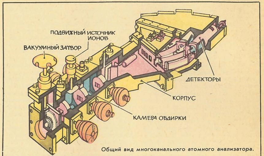
Общий вид многоканального атомного анализатора.
