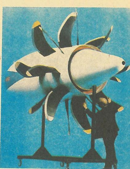
Двигательная установка с соосными винтами-вентиляторами фирмы «Дженерал электрик».
