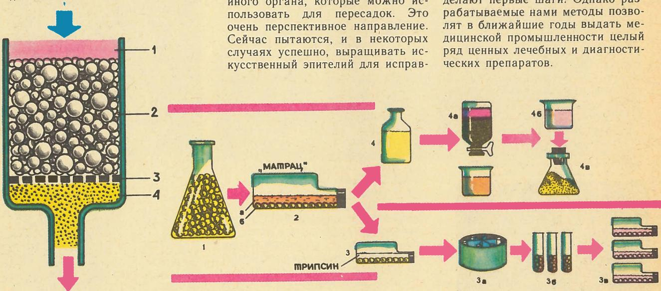
Вот по такой схеме происходит культивирование клеток, которые производят АПГ: 1 — клетки-продуценты АПГ; 2 — «матрац» с культурой клеток; 4 — культуральная жидкость, содержащая АПГ; 4<sub>a</sub> — хроматографическая колонка; 4<sub>b</sub>, 4<sub>c</sub> — получение готового порошка; 3 — снятие клеток с «матраца»; 3<sub>a</sub> — центрифуга; 3<sub>b</sub>, 3<sub>c</sub> — рассаживание клеток в три «матраца».
