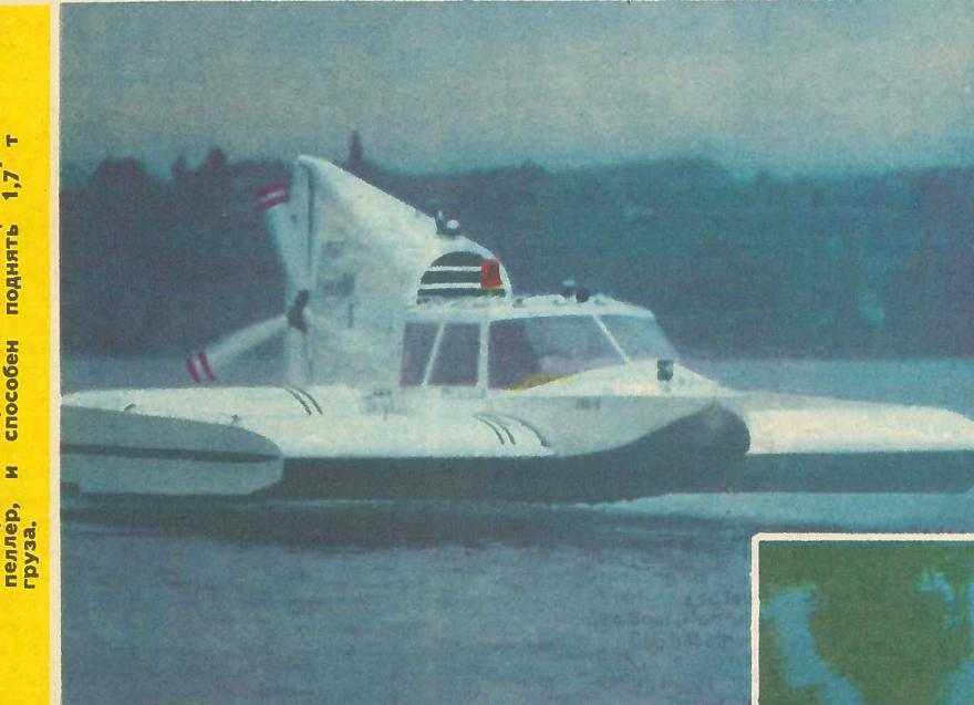
Однинадцатиметровый экранолет «Йорг-IV» над Боденским озером. Аппарат оснащен 2,8-сильным двигателем, работающим на топливном пеллет, и способен поднять 1,7 т груза.
