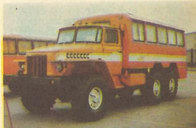
временных автобусов. Высокоэффективны системы вентиляции и отопления. Даже при 60-градусном морозе в пассажирском помещении поддерживается комнатная температура. Максимальная скорость вездехода — 75 км/ч.
