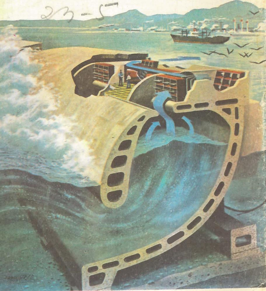
Схема движения «водяного поршня» и потоков воздуха внутри блока приливной электростанции.
