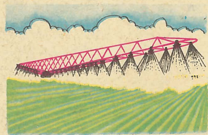
Агрегат ДДА-100М, разбрызгивая воду всего на 5—10 м, образует ласкающий землю и растения дождик.
