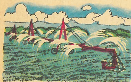
Установка «Фрегат» способна поливать круглые участки диаметром до километра.
