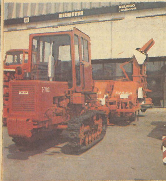
Транктор Т-70С предназначен для возделывания и уборки сахарной свеклы, картофеля и других пропашных культур.
