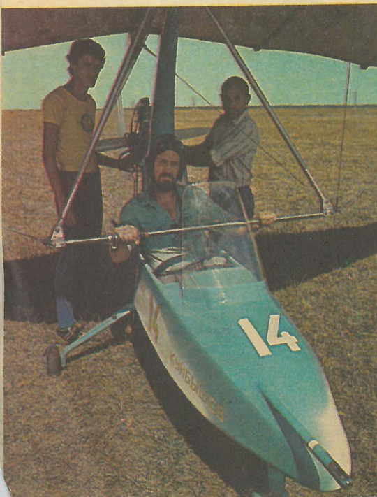
Планер «Дромадер» предназначен для обучения начинающих пилотов. Мотодельтаплан КуАИ отличается удобной гондольной тележкой.
