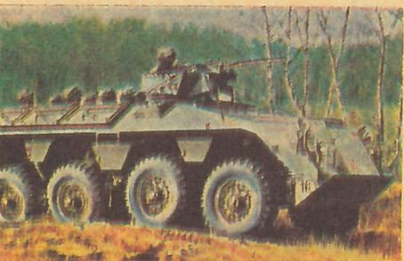
Голландский колесный БТР DAF UR-408, состоящий на вооружении армии с начала 60-х годов. Боевой вес — 12 т. Вместимость — 12 человек. Мощность дизельного двигателя — 165 л. с. Максимальная скорость по шоссе — 80 км/ч, запас хода — 500 км. Преодолевает брод глубиной до 1,2 м, стену высотой 0,7 м, ров шириной 1,2 м.
