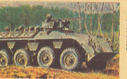
**Голландский колесный БРПЧ DAF YP-408**, состоящий на вооружении армии с начала 60-х годов. Боевой вес — 12 т. Вместимость — 12 человек. Мощность дизельного двигателя — 165 л. с. Максимальная скорость по шоссе — 80 км/ч, запас хода — 500 км. Преодолевает брод глубиной до 1,2 м, стенку высотой 0,7 м, ров шириной 1,2 м.
