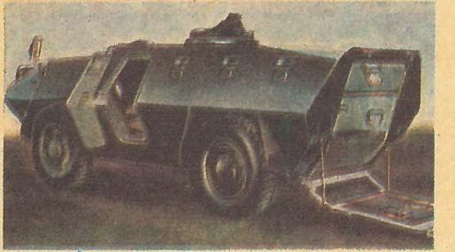
**Итальянский плавающий БРМ Фиат-6614** состоит на вооружении с 1977 года. Боевой вес — 8,5 т. Вместимость — 10 человек. Мощность дизельного двигателя — 160 л. с. Максимальная скорость по шоссе — 96 км/ч, на плаву — 4,5 км/ч, запас хода — 750 км. Вооружен башенным 12,7-мм пулеметом.
