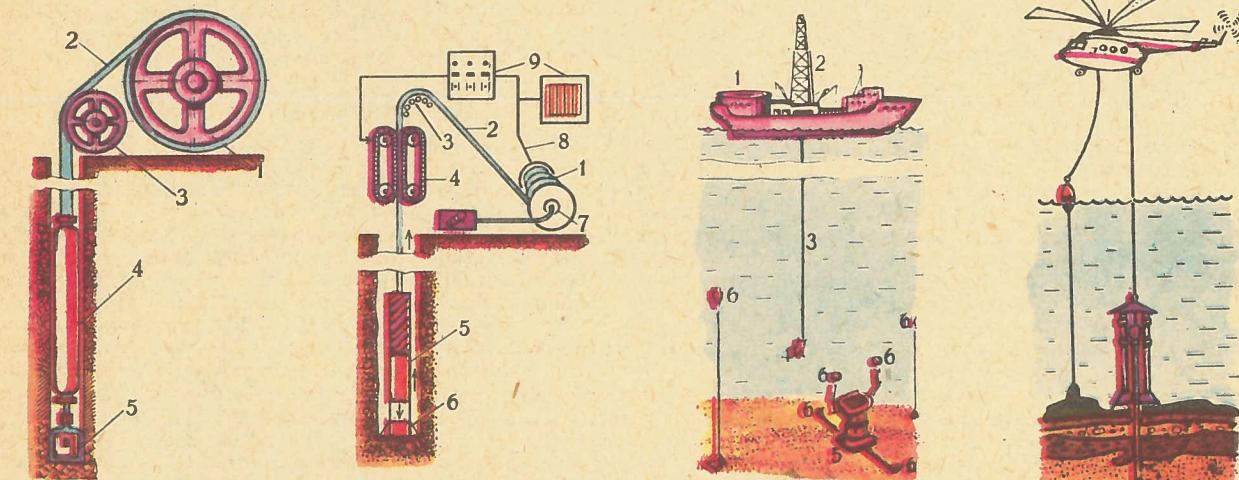
Схема одного из проектов бурения с помощью шланга, предложенных на начале нашего века. Цифрами обозначены: 1 — барабан; 2 — шланг, внутри которого проходит кабель; 3 — направляющее устройство; 4 — электробур; 5 — долото; 6 — магниевый подъемник; 7 — подача промывочной жидкости; 8 — питание электробура; 9 — блоки записи и оптимизации бурения. Стрелками показано направление движения промывочной жидкости в скважине.
