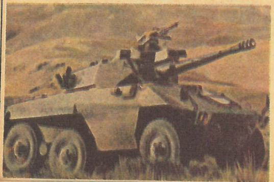
Бразильский БТР «Каскавел» принят на вооружение в середине 70-х годов. Боевой вес — 11 т. Экипаж — 3 человека. Мощность дизельного двигателя — 190 л. с. Максимальная скорость по шоссе — 100 км/ч, запас хода — 750 км. Глубина преодолеваемого брода — 1 м. Вооружен 90-мм пушкой, спаренной с турельным 7,62-мм пулеметом. Дополнительное вооружение — 7,62-мм зенитный пулемет, лазерный дальномер, беспосветочные приборы ночного видения.
