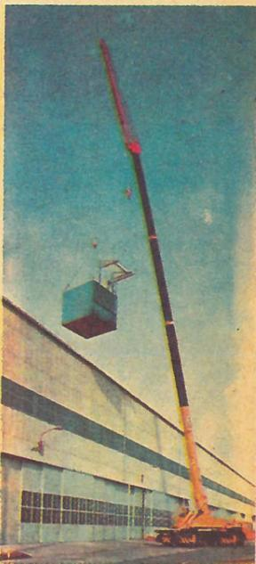
**ДЛИННОШЕЕ НА СТРОИТЕЛЬНОЙ ПЛОЩАДКЕ.** Гидравлический автокран японской фирмы «Като» широко используется в строительном дорожном работах во многих странах мира. Максимальная грузоподъемность его при сложенной стреле 30 т. Скорость подъема и опускания груза 28—74 м/мин. Длина его телескопической четырехсекционной стрелы 30 м. Но это далеко не предел. Стрела автокрана американской фирмы «Грове», к примеру, в полностью раздвинутом положении имеет длину 53,3 м! (Япония).
