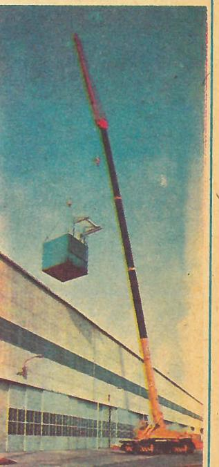
**ДЛИННОШЕЕЕ НА СТРОИТЕЛЬНОЙ ПЛОЩАДКЕ.** Гидравлический автокран японской фирмы «Като» широко используется в строительно-дорожных работах во многих странах мира. Максимальная грузоподъемность его при сложенной стреле 30 т. Скорость подъема и опускания груза 28—74 м/мин. Длина его телескопической четырехсекционной стрелы 30 м. Но это далеко не предел. Стрела автокрана американской фирмы «Грове», к примеру, в полностью развинутом положении имеет длину 53,3 м! (Япония).
