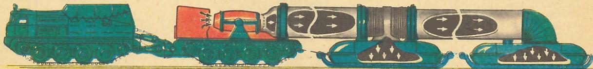
Снегоход-амфибия МПИ-18 грузо-подъемностью 600 кг при частичной разгрузке управляется передними поворотными лыжами. Когда контакт между опорной поверхностью и лыжами отсутствует, он управляется воздушным рулем.
