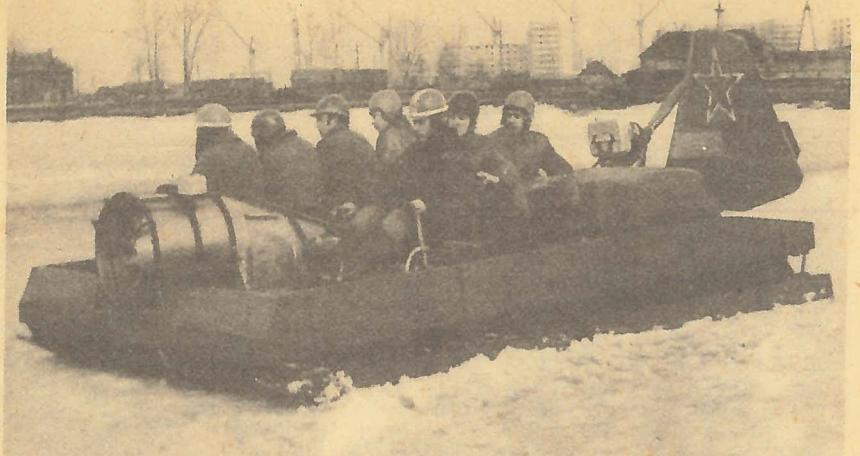
Снегоход-амфибия МПИ-18 грузоподъемностью 600 кг при частичной разгрузке управляемся передними поворотными лыжами. Когда контакт между опорной поверхностью и лыжами отсутствует, он управляет воздушным рулем.
