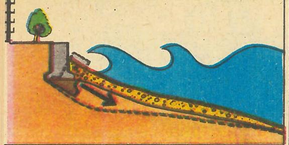
Всякое препятствие на пути штормовых волн вызывает мощное обратное течение, вымывающее грунт под фундаментом стены: море размывает и переуглубляет прибрежную зону, пока не разрушит препятствие.
