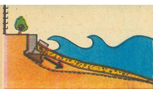
Всякое препятствие на пути штормовых волн вызывает мощное обратное течение, вымывающее грунт под фундаментом стены: море размывает и переуглубляет прибрежную зону, пока не разрушит препятствие.
