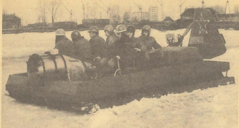
бен передвигаться со скоростью 50 км/ч. Длина машины — 9800 мм, ширина — 4500 и высота (по пилонам вентиляторной установки) — 3700 мм. Испытания показали, что по увлажненной болотистой местности, а также по поверхностям, покрытым небольшим слоем воды, САВР-2 идет с минимальными энергетическими затратами. На открытой воде давление в воздушной подушке необходимо увеличивать до 1000—1200 Па (70—80% от максимального), а при движении по сухому грунту или пашне — до максимального — 1400 Па.
