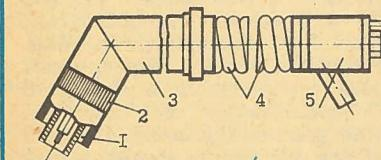
За счет разрежения вредные газы, выделяемые при сварке, удаляются через зазор, образуемый между соплом 1 и кольцом. Оптимальная скорость вытяжки обеспечивается соответствующим зазором, величина которого подбирается путем перемещения кольца вдоль рукоятки.
