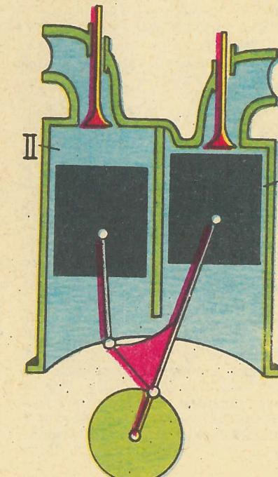
первый цилиндр вдувается сжатый воздух из второго цилиндра. Казалось бы, все хорошо. Переобогащенная смесь хорошо воспламеняется, а для дожигания продуктов сгорания есть еще целый цилиндр сжатого воздуха.
