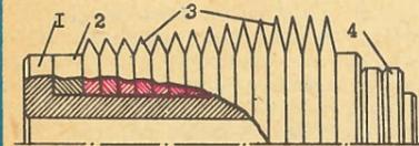
Схема оборудования для накатки ребер. Цифрами обозначены: 1 — центрирующая втулка, 2 — установочное кольцо, 3 — диск, 4 — зажимная гайка.
