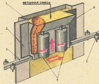
Рис. 4. Изготовление бетонных плит на вертикальном агрегате. Цифрами обозначены: 1 — бункер, 2 — стенка лотка, 3 — балка, 4 — валцы, 5 — направляющие ролики, 6 — оси валцов.
