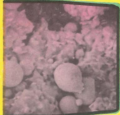
Поверхность разрушения композиционного материала (снимок на РЭМ, увеличение в 2 тыс. раз).
