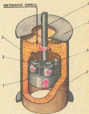
Рис. 2. Формование круглых бетонных труб. Цифрами обозначены: 1 — поддон, 2 — катки, 3 — цилиндрическая обечайка, 4 — вал, 5 — съемная пластина, 6 — оси валцов, 7 — готовое изделие.
