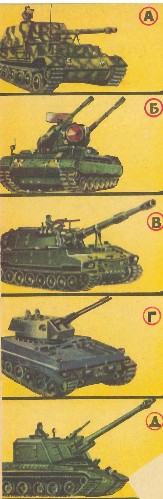
растрельные пушки (рис. В и Г), размещенные, как правило, в поворачивающихся башнях. Следует добавить, что большинство современных САО оснащены средствами защиты экипажа от радиации и отравляющих веществ.
