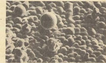
Растровая микрофотография гальванического серебряного покрытия (негладкий рельеф свидетельствует о плохом качестве покрытия).
