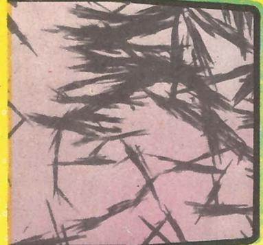
Излом сплава с эвтектической структурой (снимок на РЭМ, увеличение в 4 тыс. раз).
