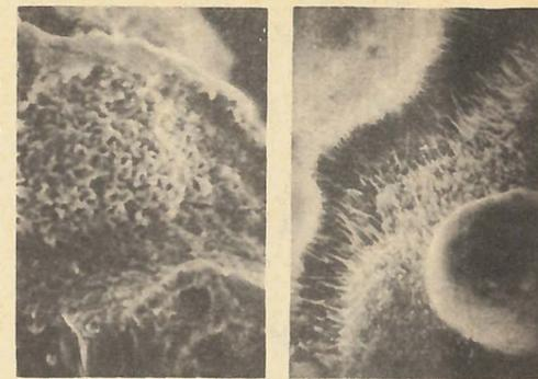
Поверхность окисленных частиц медного порошка (наличие игол, бугорков, трещин объясняет причину разной химической активности таких частиц).
