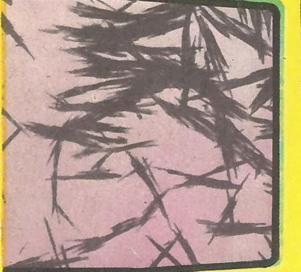
Излом сплава с эвтектической структурой (снимок на РЭМ, увеличение в 4 тыс. раз).
