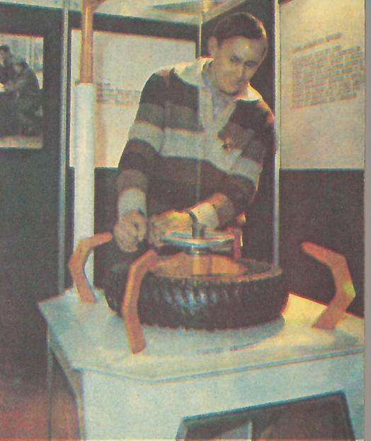
Стенд для демонтажа шин автомобилей, разработанный куйбышевским изобретателем А. Шестухиным.
