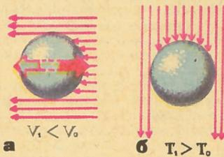
Противоречия гипотезы Лесажа: а) тела неминуемо тормозятся в потоке лесажионов; б) поглощенные лесажионы активно разогревают тела.
