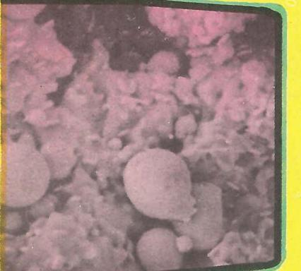
Поверхность разрушения композиционного материала (снимок на РЭМ, увеличение в 2 тыс. раз).
