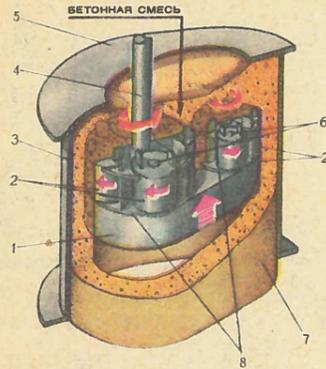
Рис. 3. Формование оvoidальных бетонных труб парой катковых устройств разного диаметра. Цифрами обозначены: 1 — поддон, 2 — валки, 3 — обечайка, 4 — вал, 5 — съемная пластина, 6 — оси катков, 7 — готовое изделие, 8 — вальцевые головки.
