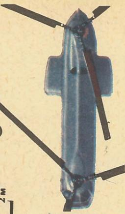
34. Вертолет «Боннг» — Вертол 107» (США, 1958 г.), двухвинтовой, продольной схемы. Два двигателя «Дженерал электрик» 158-GE-10 по 1400 л. с. Диаметр несущих винтов — 15,54 м. Полетная масса — 10 433 кг. Максимальная скорость — 267 км/ч. Динамический потолок — 4265 м. Дальность полета — 381 км.
