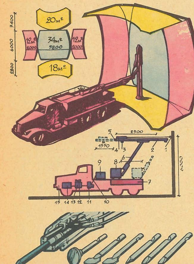
**СХЕМА УБА-1, ЧИФРАМИ ОБОЗНАЧЕНЫ:** 1 — буровой инструмент, 2 — пневмодвигатель, 3 — механизм подачи, 4 — компенсатора отдачи, 5 — пневмодвигатель, 6 — бурильный механизм подачи, 7 — бак для пневмоводо-жидкости, 8 — подвижная буровая тележка, 9 — коробка передач, 10 — вал отбора мощности, 11 — раздаточная коробка, 12 — гидропривод, 13 — коробка передач, 14 — ди-зельный двигатель ЯМЗ-238, 15 — рама автомобиля КРАЗ-256Б.
