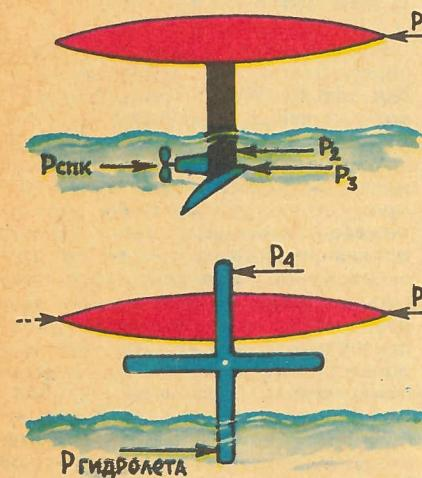
Значительная часть мощности  $P$  силовой установки СПК расходуется на преодоление сопротивления воздуха ( $P_1$ ) и встречного потока воды, действующего на стойку ( $P_2$ ) и крыло ( $P_3$ ). Гидролет испытывает только воздействие воздушного потока ( $P_4$ ) и лопасть винта ( $P_5$ ).
