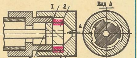
затем через щели между выступами и канавками, на выходной. Пройдя завихритель, топливо приобретает круговое движение, благодаря чему на выходе из сопла разбрызгивается. Такими форсунками отапливаются технологические линии производства асфальтобетона.
