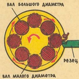
Для одновременной обработки валов большого и малого диаметров по способу Ю. Ермакова и Б. Фролова детали устанавливаются на разных расстояниях относительно оси шпинделя.
