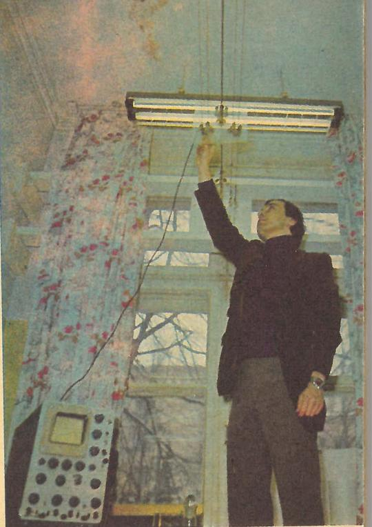
Аспирант кафедры Георгий Осепашвили у физической высокочастотной модели, имитирующей режим работы ЛЭП протяженностью 750 км. Длина модели 7,5 м, частота колебаний — 5 млн. Гц. Эта модель ЛЭП создана на кафедре электрических систем МЭИ для исследования уставновившихся режимов передачи энергии на большие расстояния.
