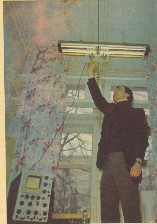
Аспирант кафедры Георгий Осепаишвили у физической высокочастотной модели, имитирующей режим работы ЛЭП протяженностью 750 км. Длина модели 7,5 м, частота колебаний — 5 млн. Гц. Эта модель ЛЭП создана на кафедре электрических систем МЭИ для исследования установившихся режимов передачи энергии на большие расстояния. Эта установка моделирует почти все физические процессы, протекающие в реальной ЛЭП.
