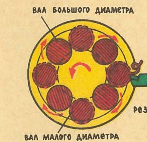
Для одновременной обработки валов большого и малого диаметров по способу Ю. Ермакова и Б. Фролова детали устанавливаются на разных расстояниях относительно оси шпинделей.
