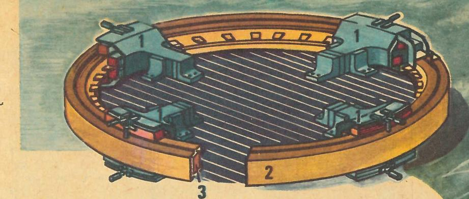
Остается откачать воздух из трубы и разогнать «астероиды» линейным двигателем. Набирая скорость, они начнут прижиматься к неподвижным боковым магнитам, при этом сцепка чуть растягивается. Когда силы отталкивания возрастают, расстояние между сцепленными массами и боковыми магнитами будет постоянным. А при торможении «астероиды» отойдут от боковых магнитов.
