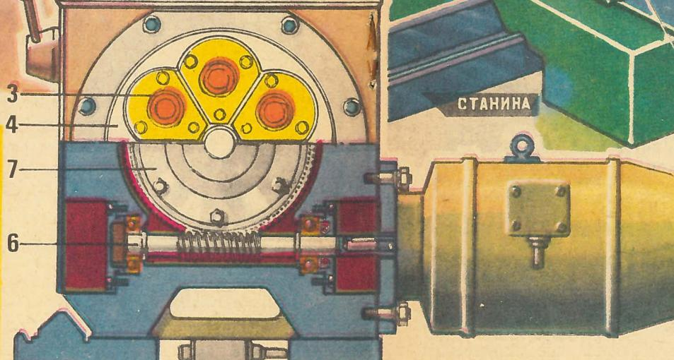
На всех схемах цифрами обозначены: 1 — суппорт, 2 — обрабатываемая деталь, 3 — шпиндель, 4 — шпиндельный блок, 5 — сменные шестерни, 6 — червяк, 7 — червячное колесо шпиндельного блока, 8 — станина.
