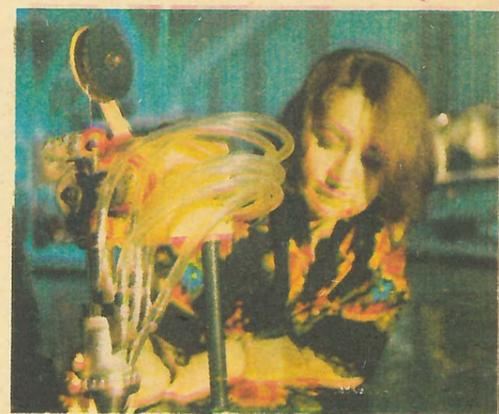
Универсальный плазматрон для дуговой сварки цветных металлов и сталей. Фото Б. Иванова.
