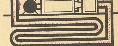
ления, в результате чего в реакторе в присутствии катализаторов (НИИГАЗ-ЗД или 10Д) происходит беспламменное дожигание паров растворителей с превращением их в водяные пары и углекислый газ, которые, проходя через трубы теплообменника к выходу в атмосферу, отдают свое тепло сушильным камерам. При этом расход электроэнергии уменьшается на 3000 руб. в год.
