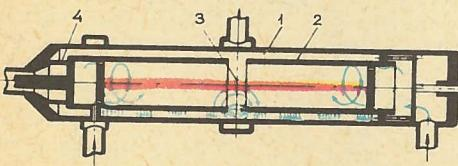
Рис. 2. Схема установки с одноКщелевым резонатором.
