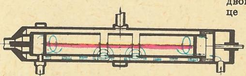
Рис. 3. Схема установки с двухщелевым резонатором.
