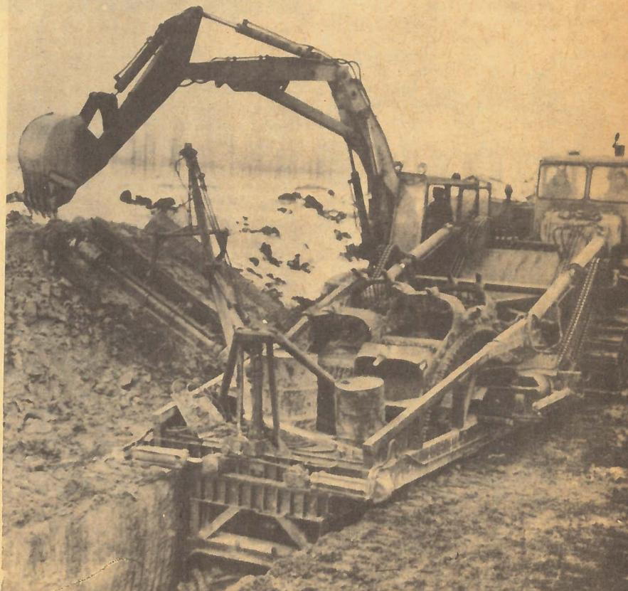
Траншеекопатель на базе трактора К-700.
