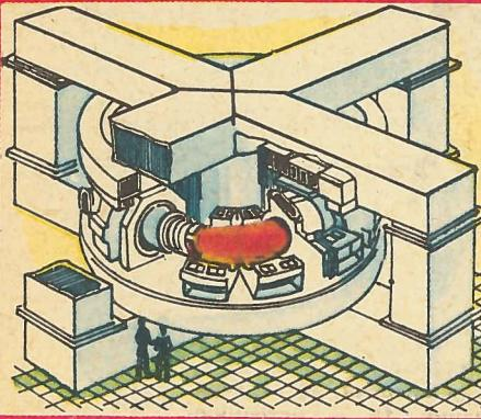
Токамак-10 — экспериментальная термоядерная установка, СССР (1975 год).
