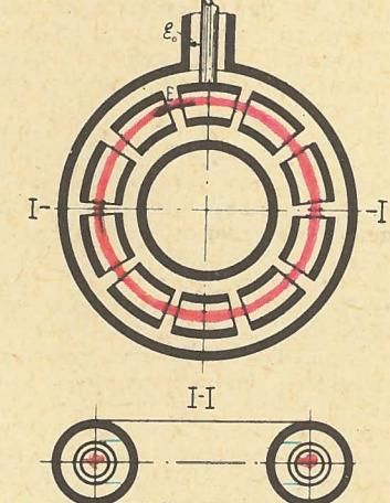
Рис. 4. Схема установки с многощелевым торoidalным резонатором.
