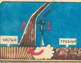
всех аппаратов прост. Через сопло отсасываются пыль и мусор, а из форсунки под давлением от 0 до 20 атм выбрасывается струя чистой жидкости, удаляющей остатки пыли и грязи. После процедуры ковры и мягкая мебель обретают абсолютно свежий вид (ФРГ).
