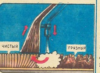
всех аппаратов прост. Через сопло отсыпаются пыль и мусор, а из форсунки под давлением от 0 до 20 атм выбрасывается струя чистящей жидкости, удаляющей остатки пыли и грязи. После процедуры ковры и мягкая мебель обретают абсолютно свежий вид (ФРГ).
