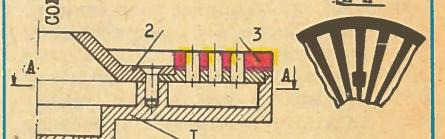
(см. рис.). Он состоит из основания 1 с лопatkами во внутренней полости (вид А-А), к которому привинчена крышка 2 с алмазным слоем 3. В последних проделаны отверстия. СОЖ подается через центральное отверстие в полость и под действием вращающихся лопаток с силой выбрасывается через каналы алмазного слоя, попадая прямо в зону контакта с металлом.
