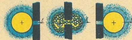
Прохождение шаровой молнии через щель в окне или двери под действием электрического поля с напряженностью  $E$ .
