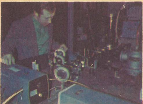
В. И. Балыкин в лаборатории лазерной спектроскопии ИСАН проводит эксперимент по лазерному охлаждению атомов.
