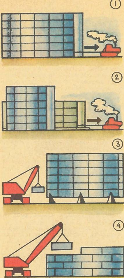
Варианты монтажа резервуаров емкостью 100 тыс. м<sup>3</sup>: 1) с однослоиной стенкой из рулонов, 2) с двухслойной стенкой из рулонов, 3) с комбинированной сборкой, 4) с полистовой сборкой.
