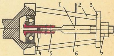
отверстие в круглой плате 3 с закрепленными на ней опорными стойками 2. На одном конце винта укрепляют планки-захваты 5. Их легонько сжимают и вставляют внутрь обоймы подшипника, после чего расклинивают ключом 4. При завинчивании гайки 7, расположенной на другом конце винта, обойма подшипника легко вынимается из гнезда, а чтобы винт не проворачивался, в конструкции съемника предусмотрен стержень 6.
