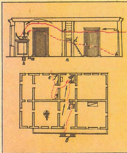
Чертеж дома Рихмана (рисунок М. В. Ломоносова): а — сени, б — план комнат. Стрелками показан путь линейного разряда, пунктиром — вероятные направления движения шаровой молнии.
