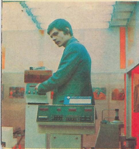
нографии. Скорость записи — 900 знаков в минуту — втрое превышает темп стенографистки средней квалификации. Беспумная клавишная система и дистанционная связь с электронной печатающей машинкой, установленной в любом соседнем помещении, позволяют синхронно записывать и расшифровывать стенограмму на любом из 12 (!) языков.
