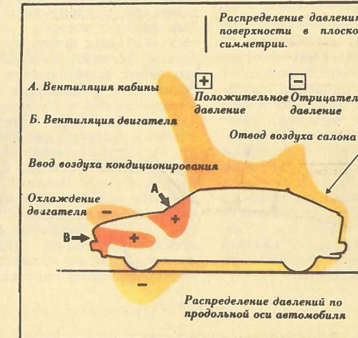
Диаграмма распределения давления воздуха в автомобиле. Ее используют при распределении холода и горячего воздуха в машине.
