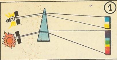
Белый свет, излучаемый источником, бывает разным. В одном случае он получается смешением синих лучей с желтыми, в другом — всех цветов спектра.
