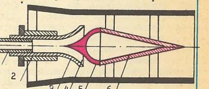
мпост от лобового удара, производимого струей сжатого воздуха. Режим продувки зависит от величины кольцевых щелей. Она меняется при повороте сопла во втулке относительно обтекателя. В выбранном положении сопло закрепляется стопорной гайкой.
