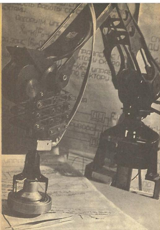
Модульный электромеханический робот РЭМ-1, предназначенный для обслуживания технологических процессов в агрессивных средах. Эту систему разработали в прошлом году инженеры и студенты машиностроительного факультета МВТУ.
