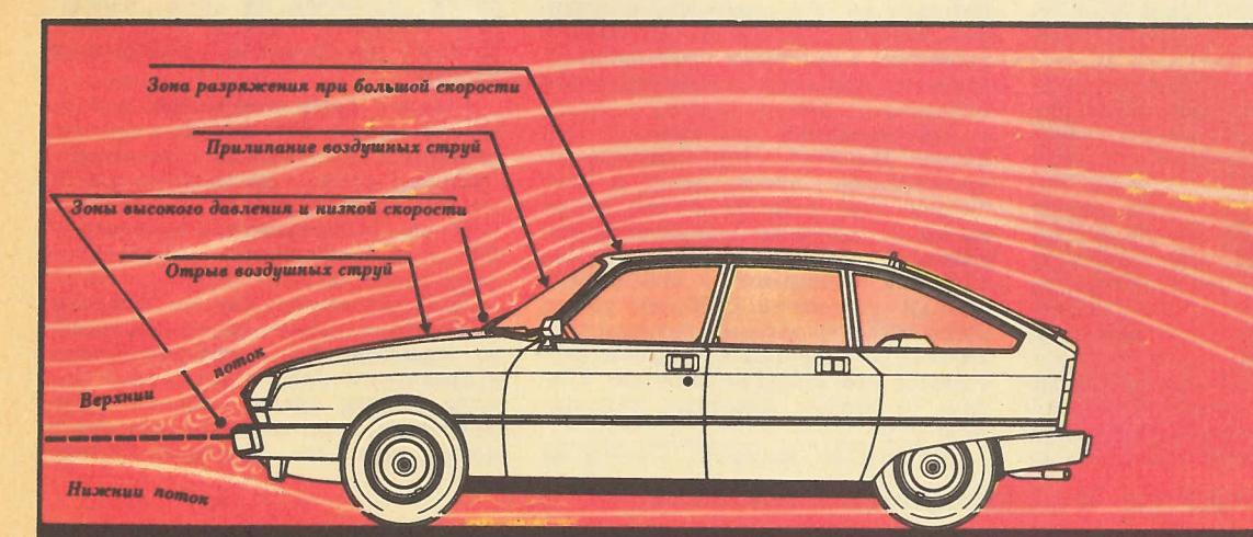
При опытах в аэродинамической трубе инженеры установили, как встречный поток воздуха обтекает корпус автомобиля, определяет оптимальные режимы работы двигателя на разных скоростях.
