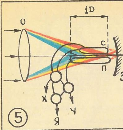
Использование хроматической aberrации в конструкции прибора: О — хрусталик, П — простой приемник, С — сложный приемник, З — зеркало, Х и У — выводы сигналов цветности, Я — вывод суммарного яркостного сигнала.
