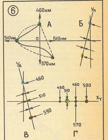
Частные случаи работы прибора. Цветовые области: А — нормального глаза, Б — протанопа, В — дейтеранопа, Г — тристанопа.
