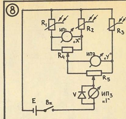
Схема простейшего прибора, имитирующего работу глаза.
