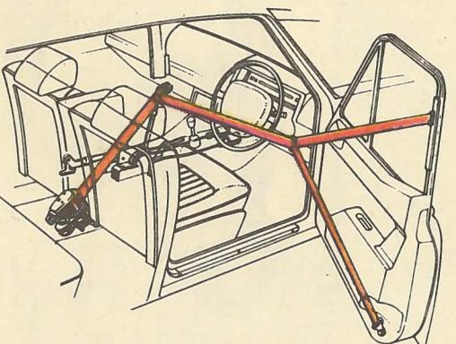
Схема ремней безопасности, автоматически охватывающих водителя, когда он садится в машину.
