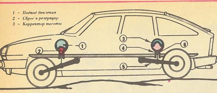
Схема гидропневматической подвески автомобиля «Ситроен ЖС» (рисунок слева). Каждое колесо связано с кузовом рычагом (5), образующим единое целое с поршнем (6). Этот поршень перемещается в цилиндре (4), воздействуя на особую минеральную жидкость (2), которая, в свою очередь, сжимает газ (1), находящийся в пневматической пружине.
