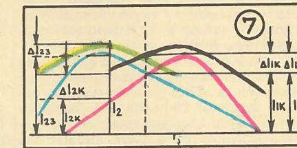
Адаптация прибора к спектральному составу излучения происходит за счет логарифмической зависимости фотоответа от яркости. В точке пересечения кривых поглощения изменение интенсивности излучения не меняет цветового сигнала:  $\Delta I_{1k} = \Delta I_{13}$ , а вне ее меняет:  $\Delta I_{2k} \neq \Delta I_{23}$ .
