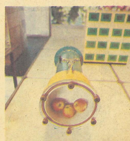
На снимке: стеллаж и газовый анализатор ВГА-1.
