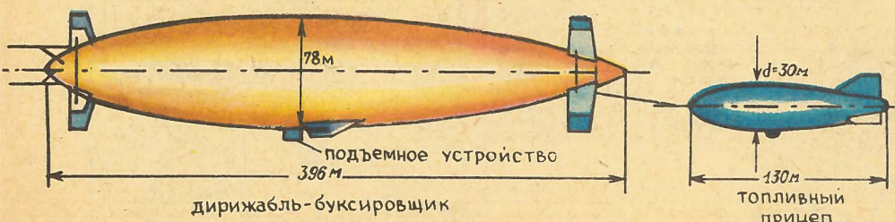
Проект грузового дирижабля, снабженного дополнительным буксируемым отсеком с запасом топлива.
