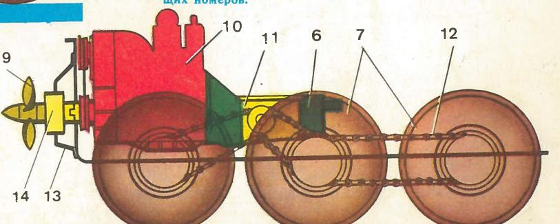
тают непосредственно на ход, но при всем этом приводы их существенно отличаются. Цифрами обозначены: 1 — направляющая реверса; 2 — корпус водомета; 3 — механизм включения водомета; 4 — муфта включения водомета; 5 и 10 — двигатель; 6 — коробка передач; 7 — колесо; 8 — вал винта; 9 — винт; 11 — раздаточная коробка от ЛуАЗа; 12 — бортовая передача (цепная); 13 — кронштейны крепления ходового винта; 14 — втулка винта; 15 — привод включения винта.
