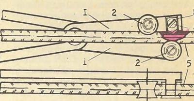
щен между роликами, и они легко скользят по нему в то время, как резец вспарывает оболочку. Глубина разреза в зависимости от толщины изоляции регулируется винтом 4, потому этот инструмент совершенно не повреждает жилы кабеля. Материалом для рычагов, роликов и винта выбиралась любая углеродистая сталь, для резца же нужна инструментальная, с достаточно высокой твердостью после закалки.
