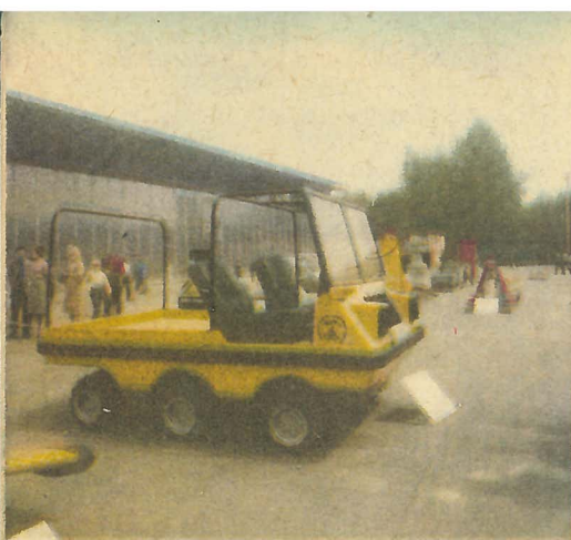
Небольшой вездеход, представленный изобретателями МВТУ имени Н. Баумана, определенно понравится геологам, охотоведам — словом, тем, кто трудится в сложных условиях. При скорости 45 км/ч машина эта способна перевозить до 350 кг груза.
