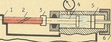
ремещает, поршень (5). Поршень давит на жидкость. Ее давление по закону Паскаля передается равномерно на шток и мембрану манометра. Подвижный упор (3) перемещается и сжимает кольцо до установленного ГОСТом размера. Стрелка на шкале показывает величину силы сжатия.
