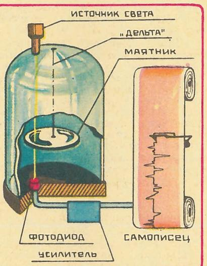
Принципиальная схема фибрillлярного потенциометра ФП-1.
