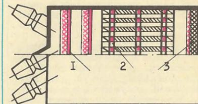
струя воздуха проходит через диафрагму, лепестки ее сжимаются под действием низкочастотных колебаний, уменьшая тем самым отверстие, а следовательно, и диаметр воздушного потока. Высокочастотные колебания поглощаются в сотовых гасителях, а затем глушатся экраном. Он одновременно служит и сепаратором, задерживая частицы масла, попавшие в отработанный воздух. Они удаляются через отверстие в днище. Сам глушитель устанавливается в нишах рамы машин.
