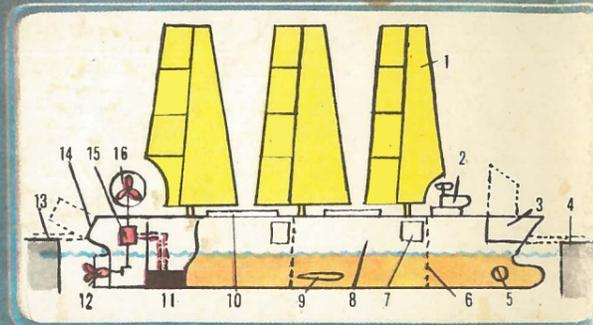
1 — парус-крыло с высокой механизацией; 2 — ходовой мостик; 3 — подъемная часть носа; 4 — носовая аппарель; 5 — подруливающее устройство; 6 — съемные переборки; 7 — бортовые лацпорты; 8 — корпус судна; 9 — бортовые крылья — рули для откренивания; 10 — солнечные батареи приборов; 11 — аккумуляторные батареи, служащие одновременно твердым балластом; 12 — активный руль с электродвигателем; 13 — кормовая аппарель; 14 — кормовые ворота; 15 — мотор-генератор; 16 — вспомогательный электродвигатель.
