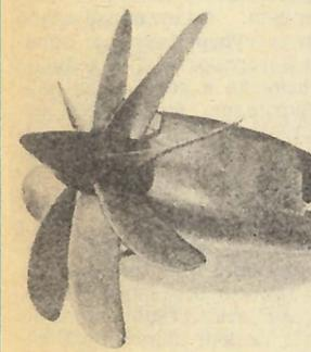
душные флотилии потребляют его все больше и больше, внимание конструкторов вновь должно обратиться к винтам. Естественно, это будет пропеллер нового поколения. Для увеличения нагрузки его диаметр следует уменьшить на 45%, в качестве материала для изготовления использовать армированную стальными волокнами смесь графита и эпоксидной смолы. Режущие кромки, работающие при более жестких условиях, изготовить из титана.
